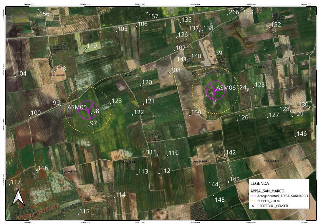
Individuazione planimetrica dei ricettori nel buffer di 210 metri per la pala intera (GIALLA)
