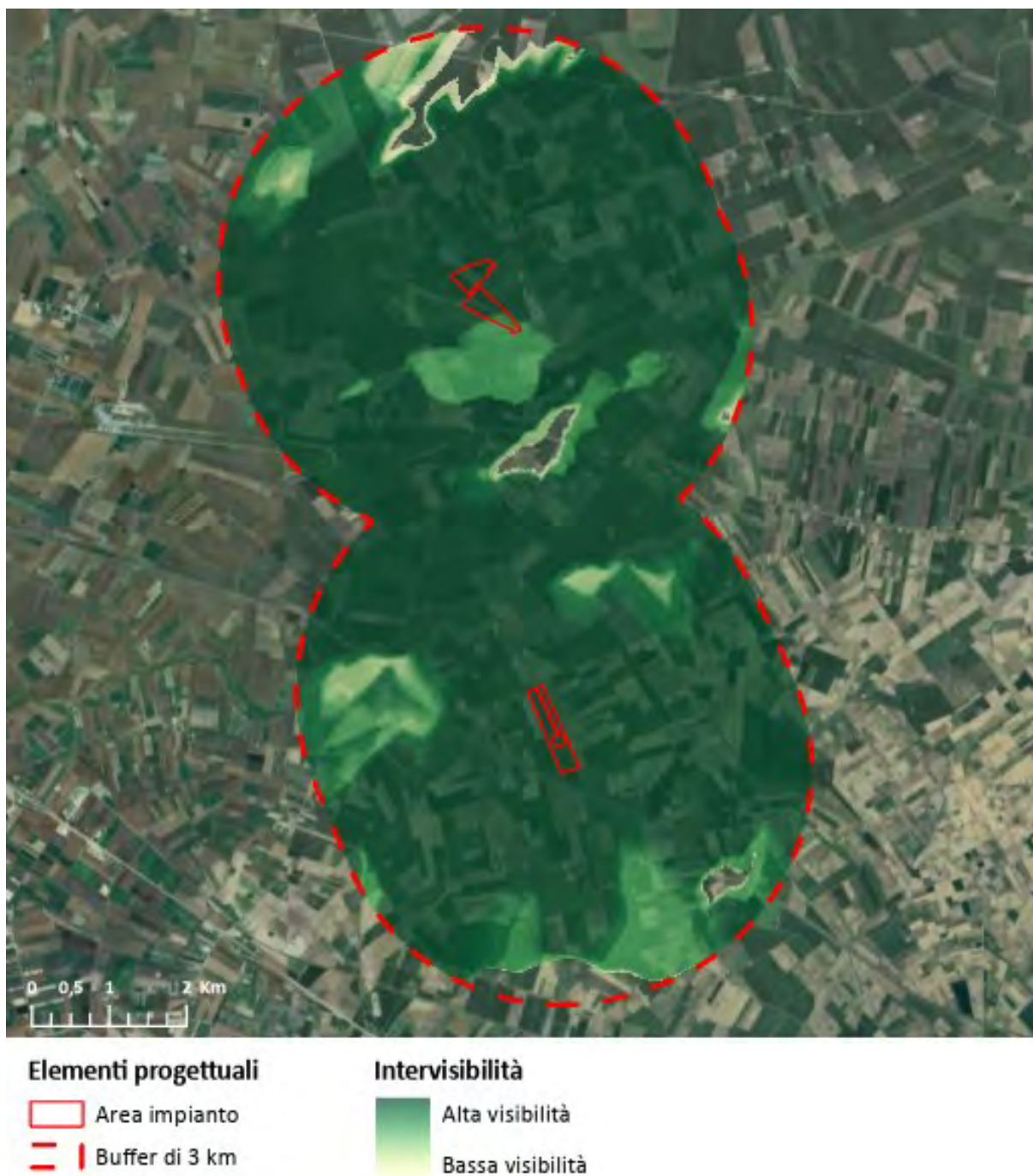
Figura 9.1: Intervisibilità Teorica nell'Area Buffer – Classi di Intervisibilità
