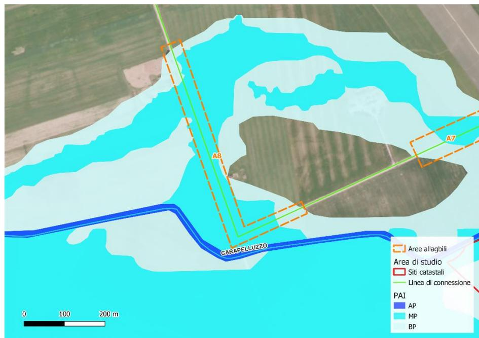
Figura 5.43: Stralcio PAI. In arancione tratteggiato il tratto della linea di connessione in area A6 con pericolosità bassa e media. In verde la linea di connessione e in rosso l'area del campo fotovoltaico.
