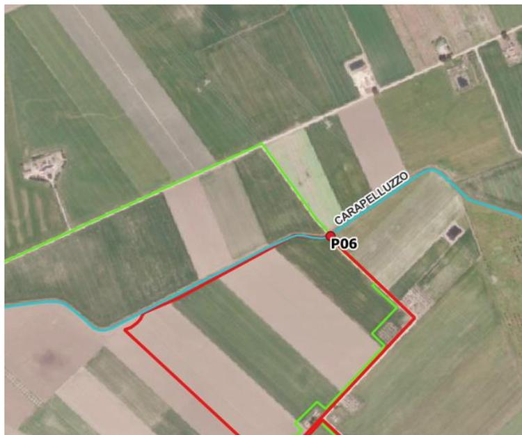
Figura 5.26: Ortofoto ubicazione interferenze P05. In verde la linea di connessione, in nero la cabina d'ampliamento, in rosso il sito di progetto e in azzurro il reticolo idrografico.
