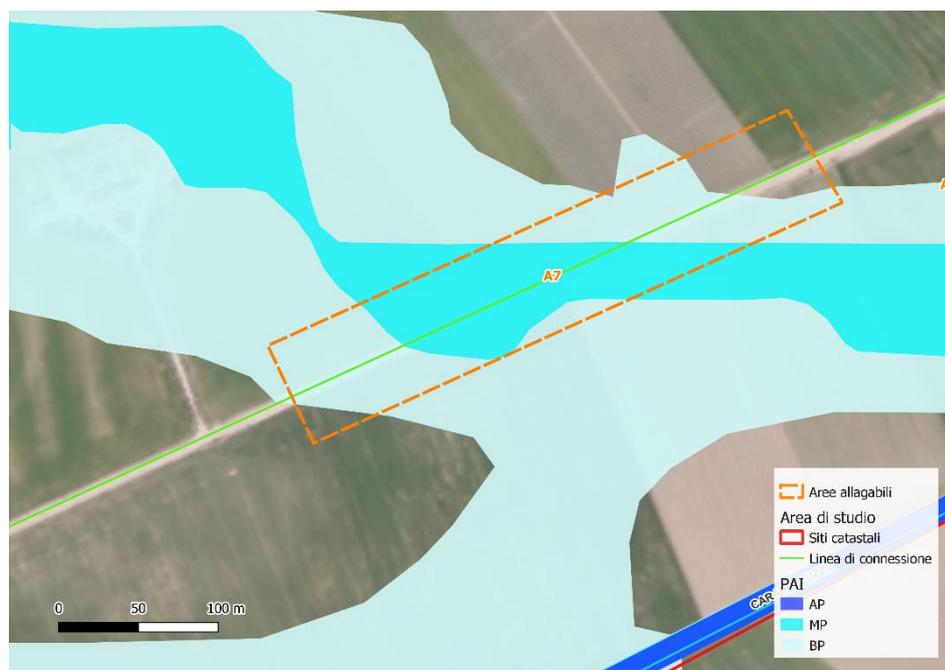
Figura 5.41: Stralcio PAI. In arancione tratteggiato il tratto della linea di connessione in area A6 con pericolosità bassa e media. In verde la linea di connessione e in rosso l'area del campo fotovoltaico.
