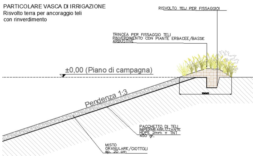
Figura 7.9: Particolare vasca di irrigazione: risolto in terra per ancoraggio teli con rinverdimento.
