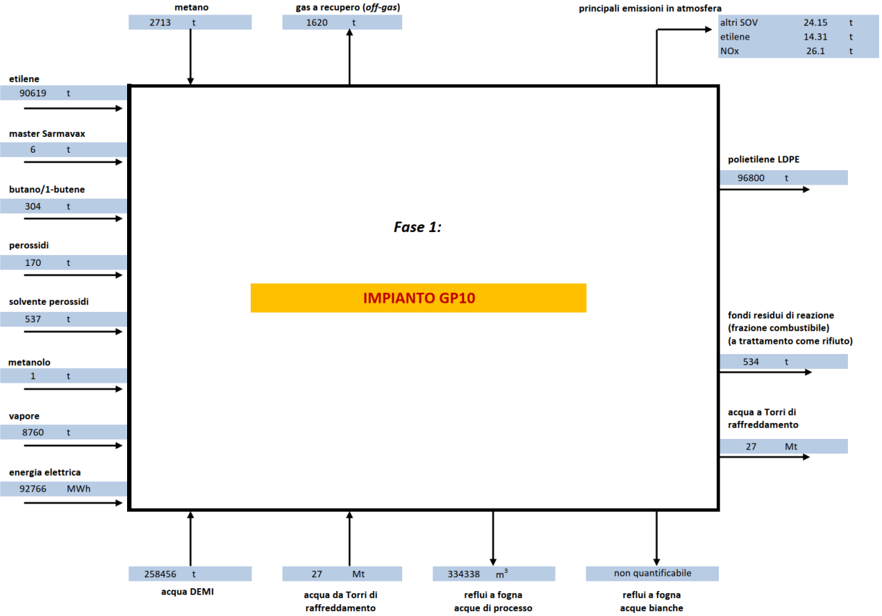
Figura 7. Schema a blocchi Fase 1 - Impianto GP10 post modifica
