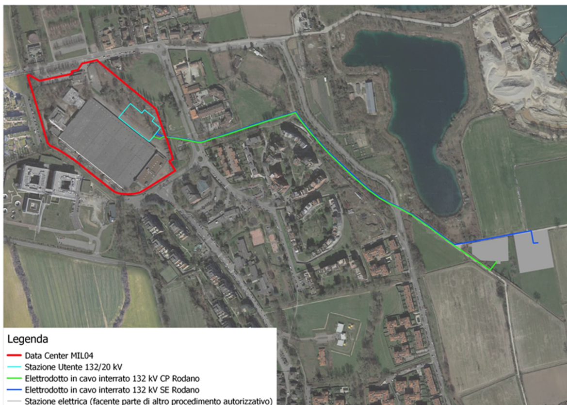
Figura 4-1: Nuova Stazione Utente per MIL04 e collegamento alla Cabina Primaria esistente e alla Stazione Elettrica in progetto nel comune di Rodano
