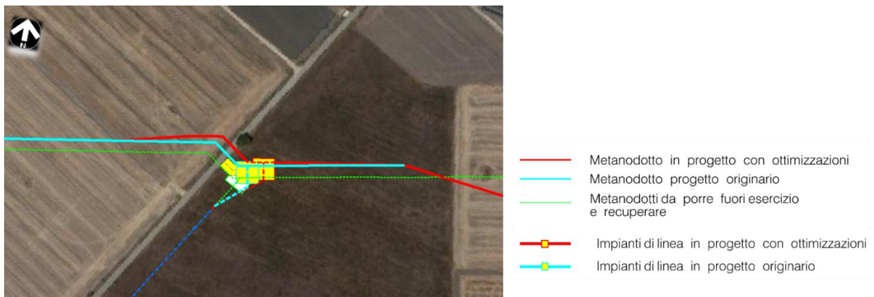
Figura 9 - Aerofotogrammetria dell'area di intervento dell'ottimizzazione 2
