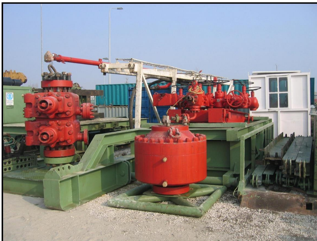
Figura 5.5a Esempi di BOP “Ram” (a Sinistra) e “Annular” (a Destra)
