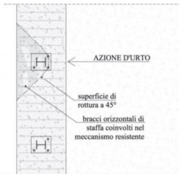
Figura 94: cono di diffusione verifica staffe orizzontali
