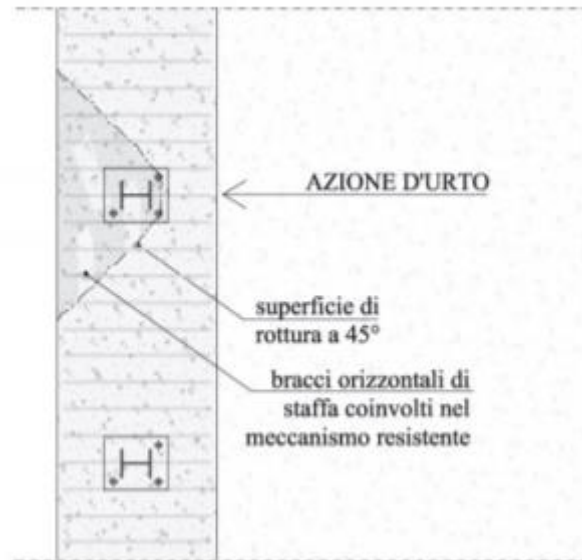
Figura 21: cono di diffusione verifica staffe orizzontali
