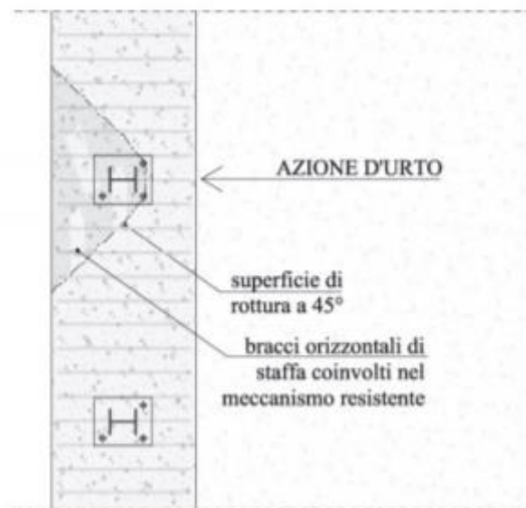
Figura 26: cono di diffusione verifica staffe orizzontali
