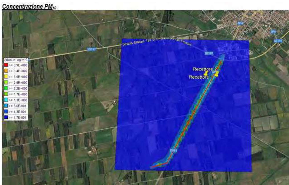
Figura 2 - Scenario di cantiere – Concentrazione media di PM10
