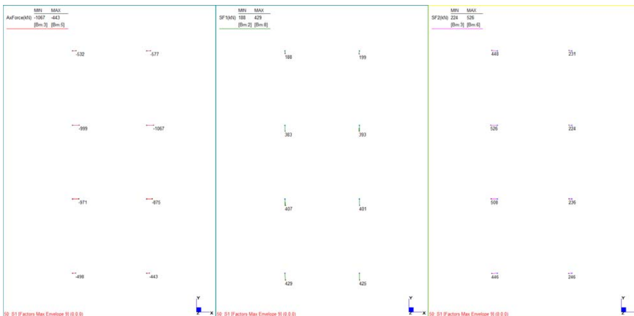
Figura 13.23: Sforzi sui pali – SLV massimo involucro
