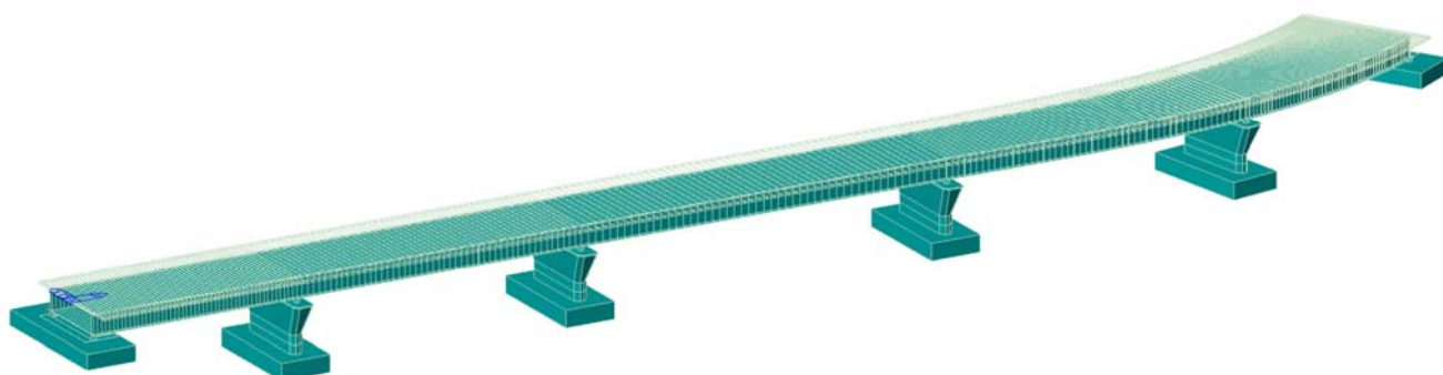
Figura 8.1: Modello FEM dell'impalcato e delle pile
