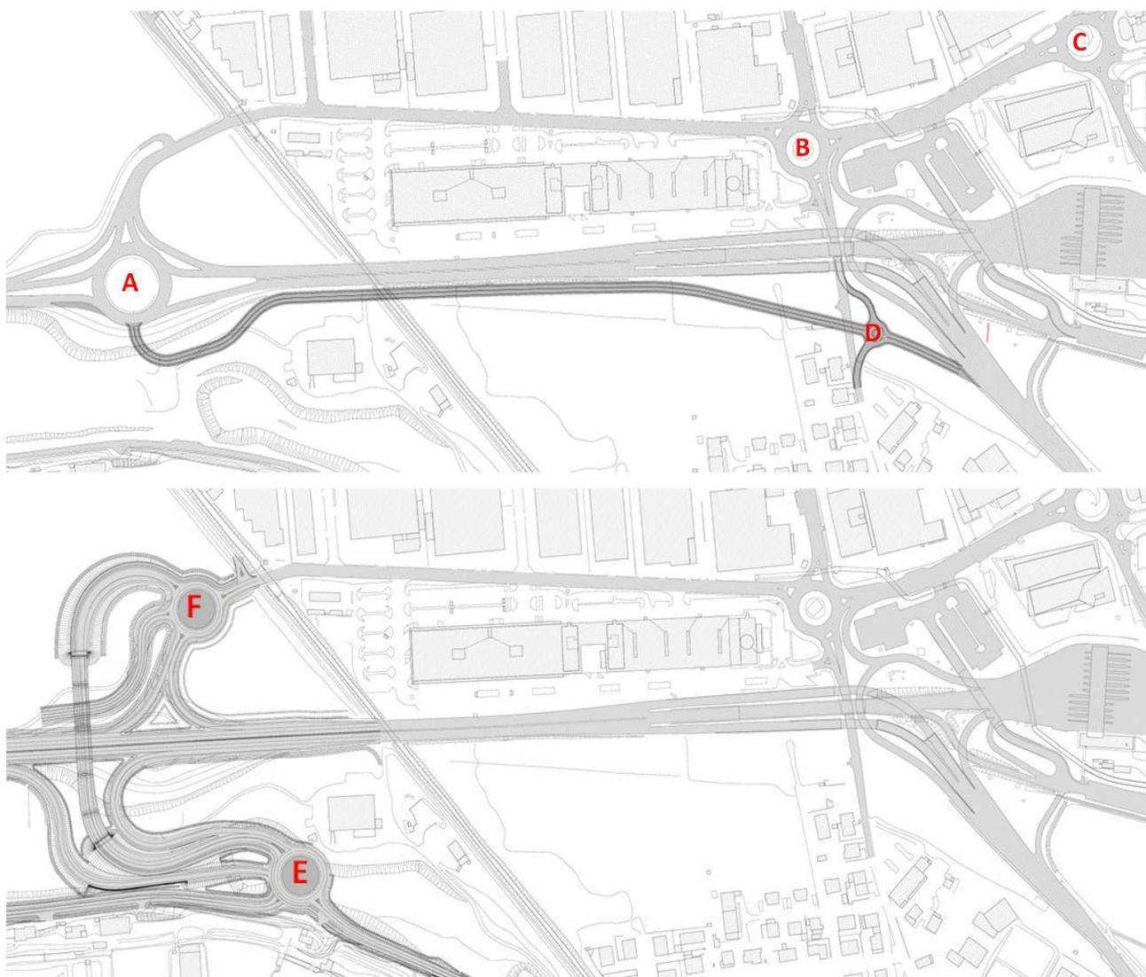
**Figura 10.2: Rotatorie oggetto di verifica di funzionalità. Assetto Attuale, assetti di Cantierizzazione e Assetto di configurazione Finale**
