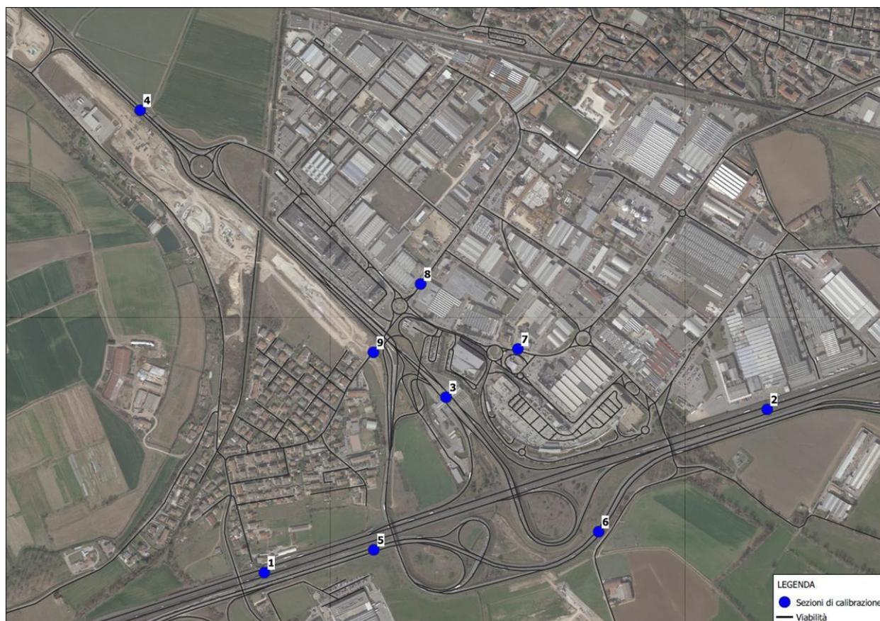
**Figura 7.3: Localizzazione delle sezioni di traffico utilizzate per l'espansione e calibrazione delle matrici O/D campione estratte dalla banca dati TomTom MOVE**
