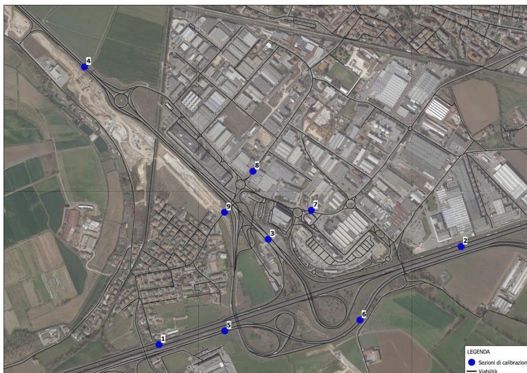
**Figura A.10: Localizzazione delle sezioni di traffico utilizzate per l'espansione e calibrazione delle matrici O/D campione estratte dalla banca dati TomTom MOVE**
