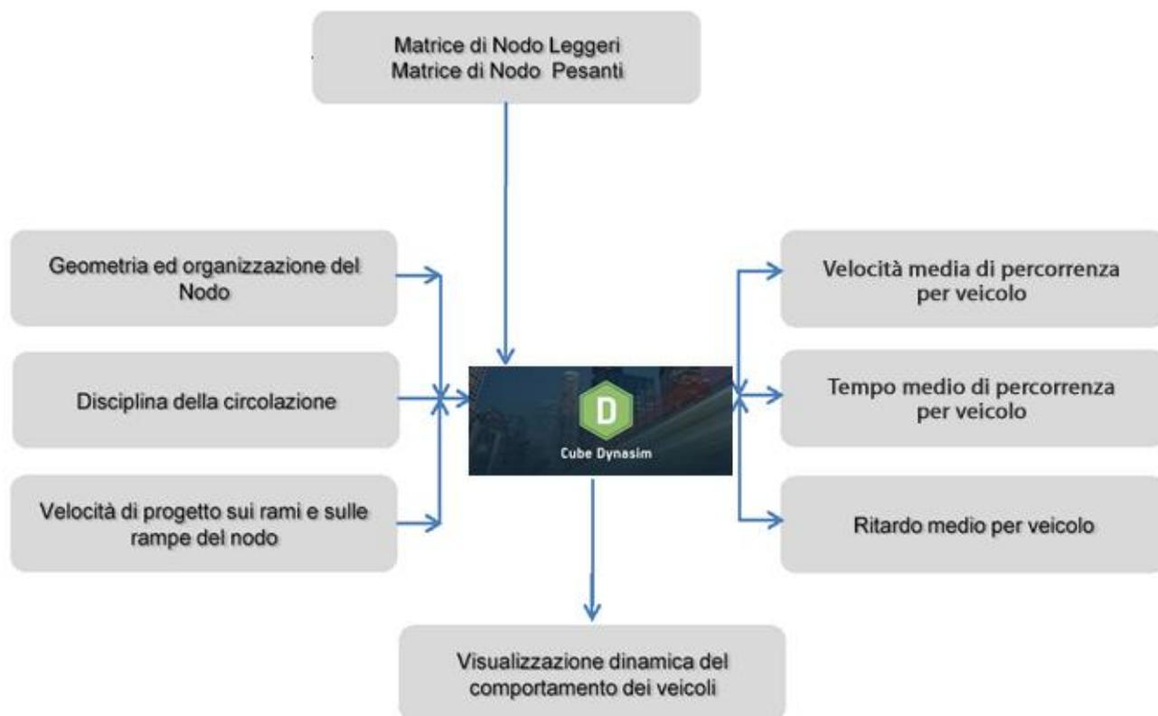
Figura 8.8 Struttura, input ed output del modello
