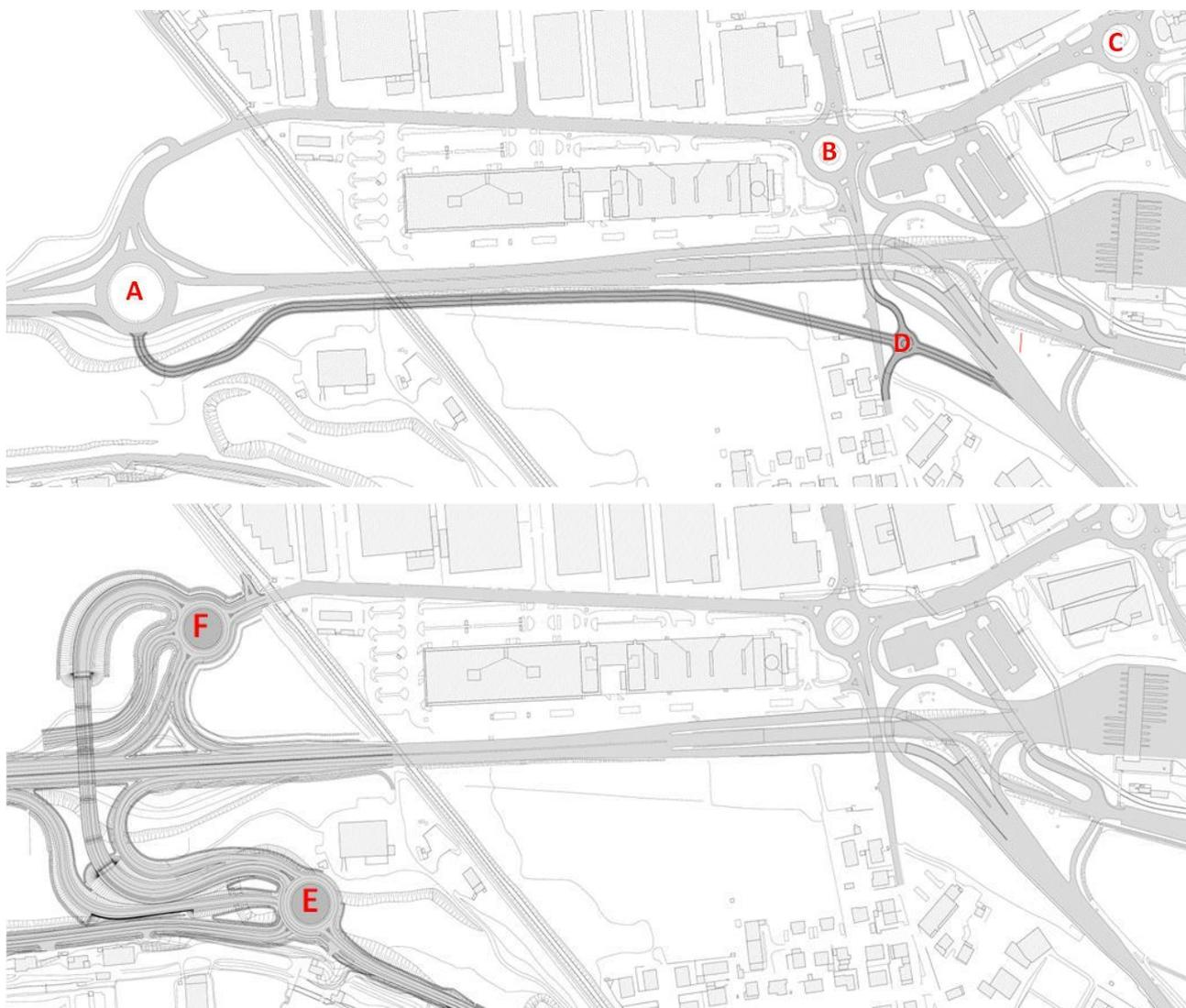
**Figura 9.3: Rotatorie oggetto di verifica di funzionalità. Assetto Attuale, assetti di Cantierizzazione e Assetto di configurazione Finale**
