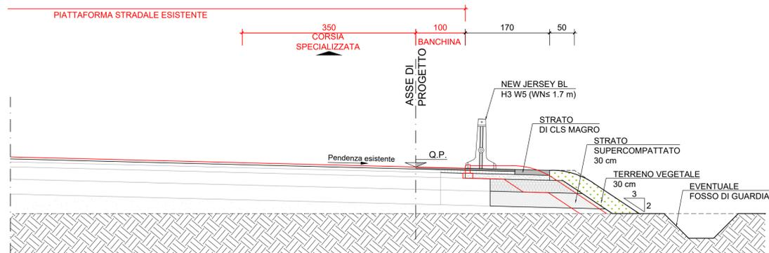
SEZIONE TIPO CORSIA SPECIALIZZATA IN RILEVATO - 1:50
