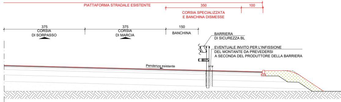
SEZIONE TIPO INNESTO VIA PONTARA SANDRI - 1:50
