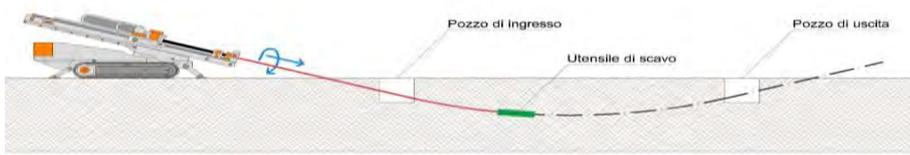
2) Perforazione pilota (pilot bore): mediante una macchina operatrice si realizza una perforazione normalmente di piccolo diametro che viene manovrata attraverso la combinazione di rotazioni e spinte il cui effetto, sulla traiettoria seguita dall'utensile di scavo, è controllata attraverso un sistema di guida radiocontrollato. La perforazione pilota può seguire percorsi piano-altimetrici preassegnati che possono contenere anche tratti curvilinei.
