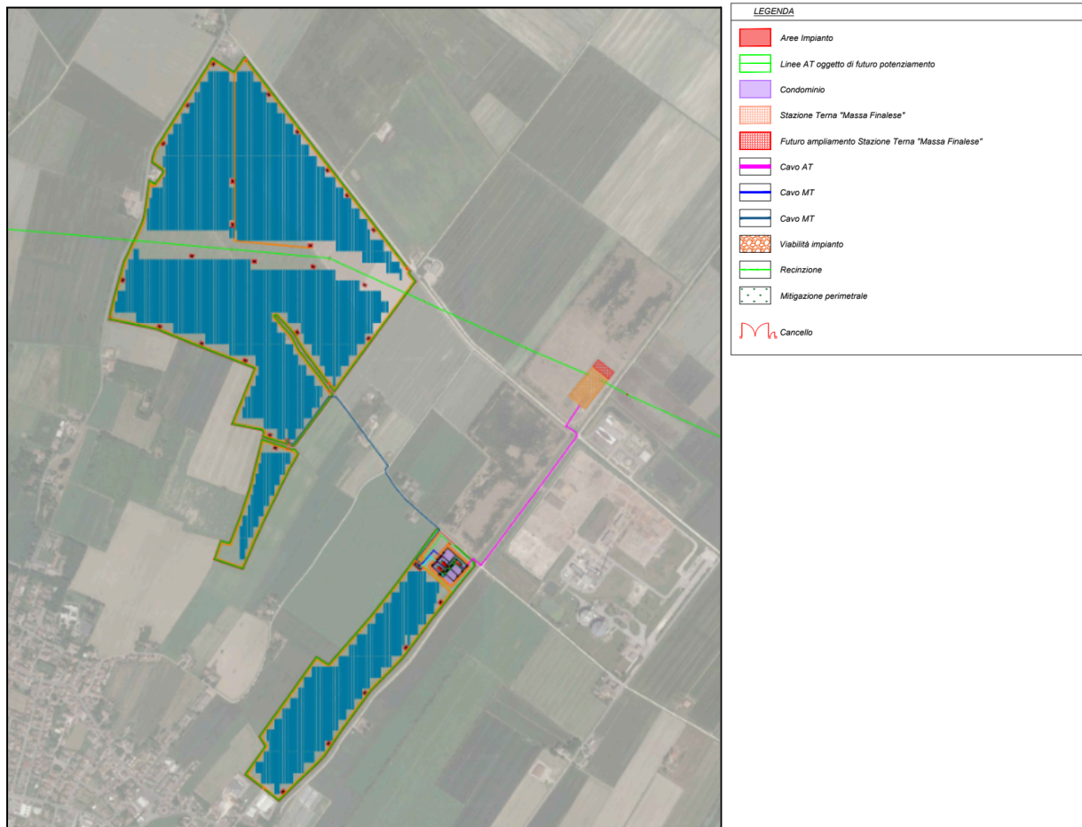
Fig. 2 - Linee e cabine elettriche in progetto
