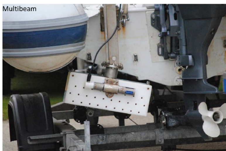
Figura 6: Sistema rotazione testa trasduttore
