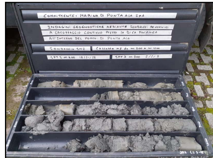
Photo n.24: SM2 Cassetta 2 da 5,0 a 10,0 m di profondità
