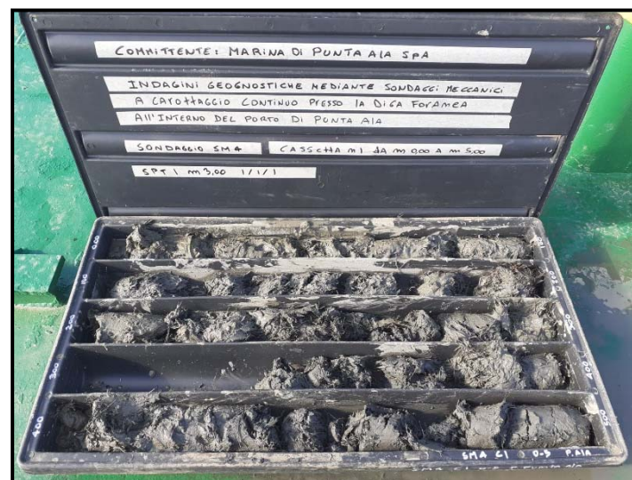
Photo n.40: SM4 Cassetta 1 da 0,0 a 5,0 m di profondità
