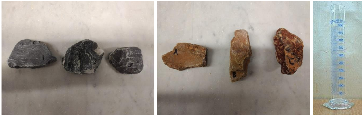
Figura 4 – Massi campioni per la determinazione del peso specifico e cilindro graduato
