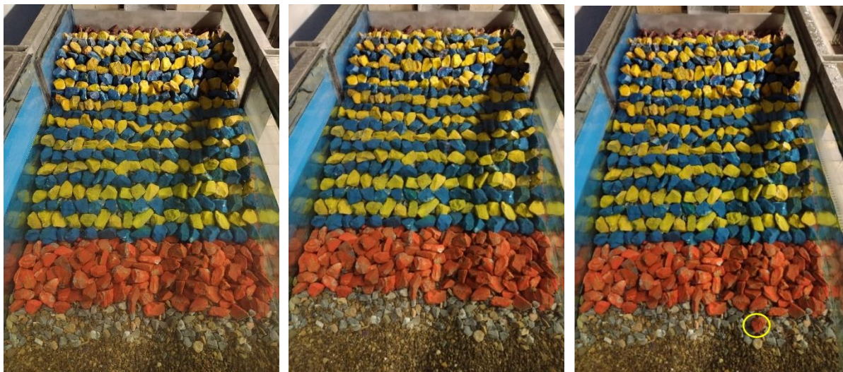
Figura 26 – Avandiga Foranea Maestrale – Fase 2: a sinistra vista iniziale; al centro vista al termine del moto ondoso H04; a destra vista al termine del moto ondoso H05
