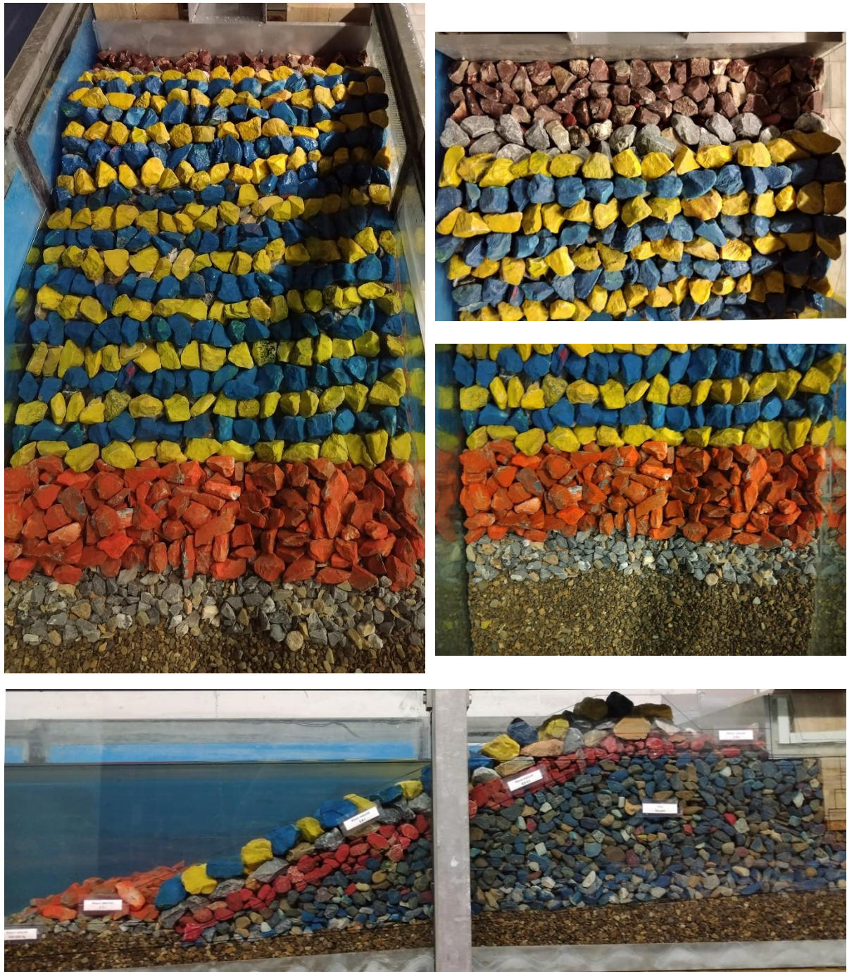
Figura 20 – Sezione D1 - in alto a sinistra vista frontale; in alto a destra vista della vasca di laminazione; in basso a destra vista della berma al piede; in basso vista laterale.
