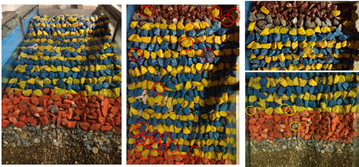
Figura 23 – Avandiga Foranea Maestrale – Fase 1: a sinistra vista frontale; al centro individuazione dei massi dislocati sulla mantellata; a destra in alto particolare della vasca di laminazione; a destra in basso individuazione dei massi dislocati sulla berma al piede
