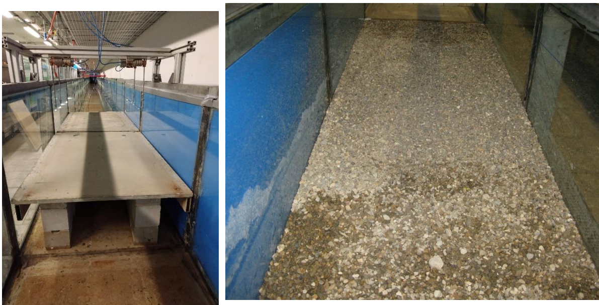
Figura 3 - Realizzazione del doppio fondo in canale per la riproduzione delle batimetriche dal piede della struttura alla -20.0m s.l.m.
