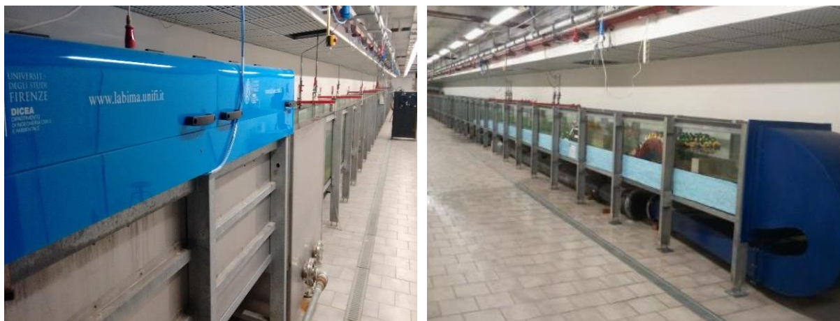
Figura 2 - Il canale utilizzato per la conduzione dello studio in esame, presso il LABIMA - Laboratorio di Ingegneria Marittima del DICEA-UNIFI.
