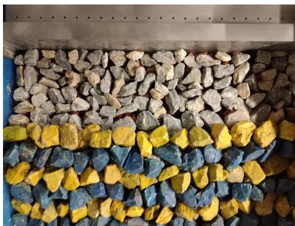
Figura 33 – Diga Foranea Maestrale – sezione M1 – i. Posa dello strato filtro; ii Posa del primo strato di mantellata; iii. Vista frontale; iv. Vista dalla pensilina box; v. Vista laterale; vi. Particolare vasca di laminazione; vii. Particolare piede dell’opera
