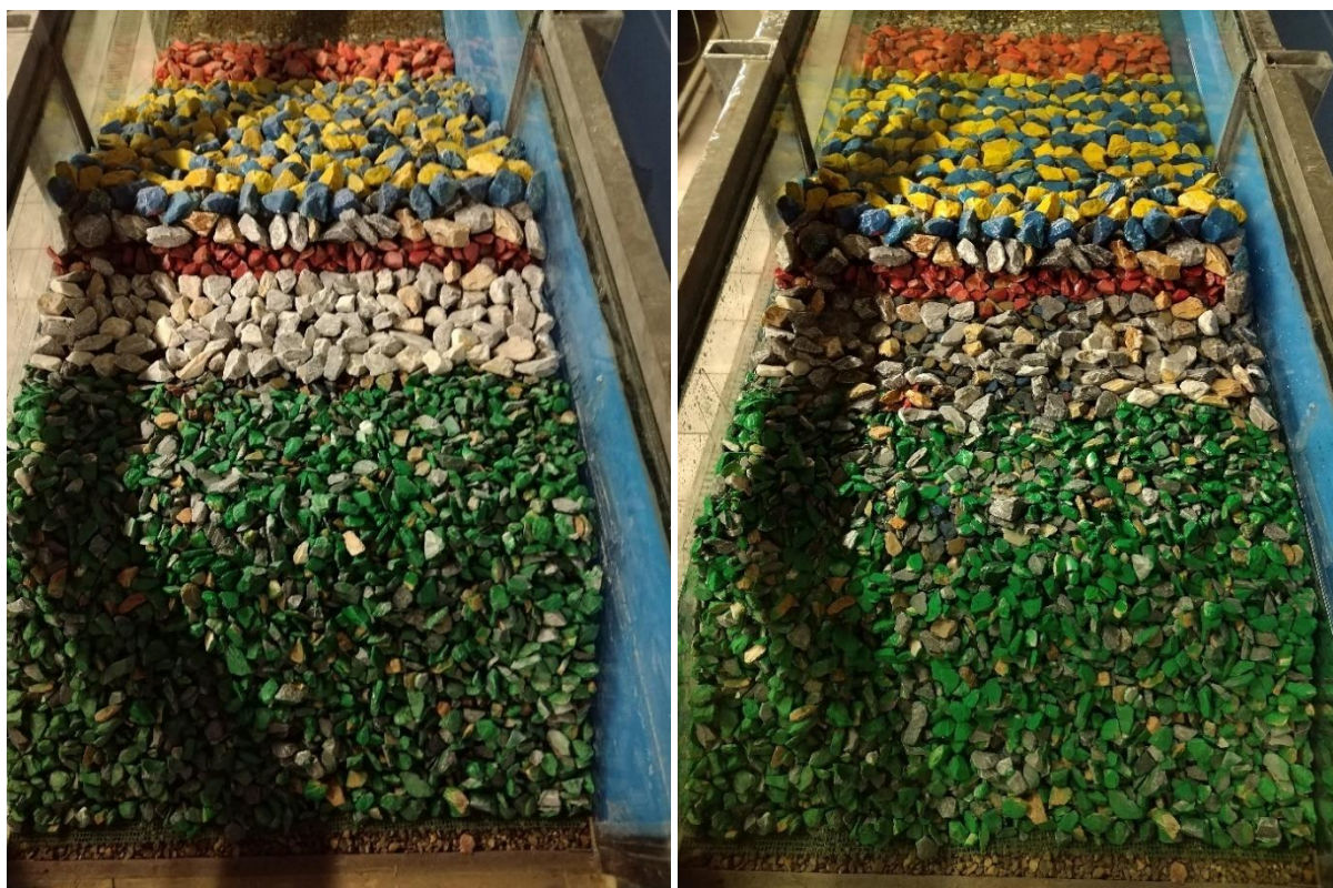
Figura 31 - Configurazione D3: iniziale (a sinistra) e post H10 (a destra) – vista dal porto verso il mare
