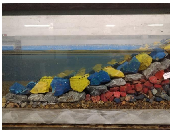
Figura 33 – Diga Foranea Maestrale – sezione M1 – i. Posa dello strato filtro; ii Posa del primo strato di mantellata; iii. Vista frontale; iv. Vista dalla pensilina box; v. Vista laterale; vi. Particolare vasca di laminazione; vii. Particolare piede dell’opera
