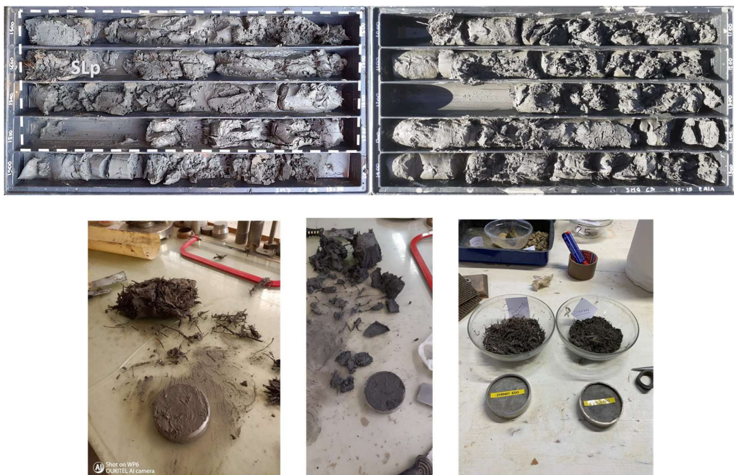
Materiale impiegato per le prove: sondaggio SM3 (sx) e SM4 (dx); preparazione dei campioni in laboratorio
