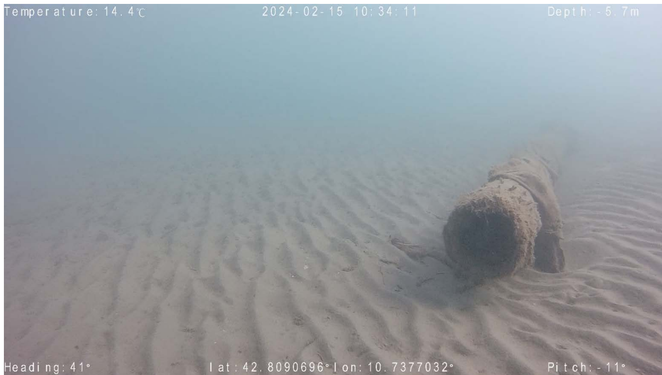
Figura 37- transetto 9: Porzione di tubazione sul fondo, già identificata in Fig.32 corredata di fasce per la movimentazione.
