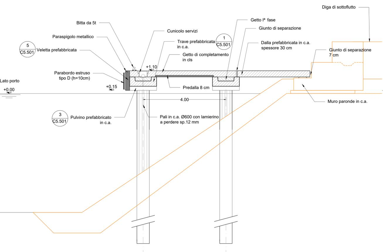
**B** BANCHINA CANTIERE - SEZIONE TIPO IN CORRISPONDENZA DELL'ASSE DEI PALI
