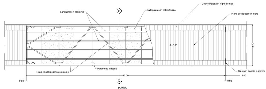
A SEZIONE TIPO PONTILE GALLEGGIANTE
