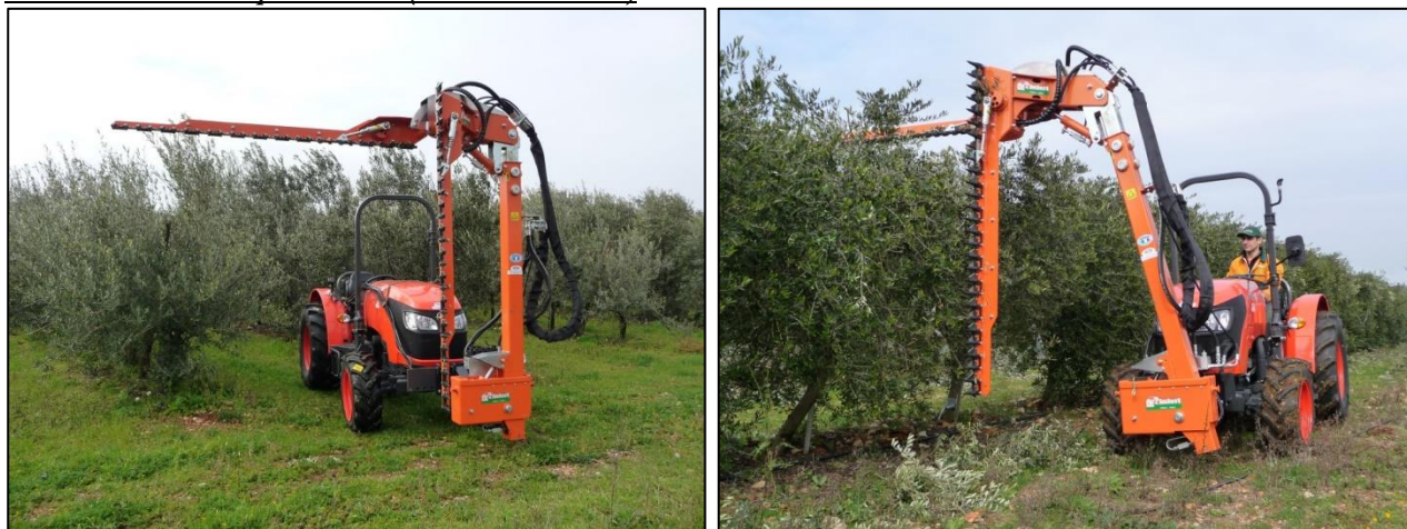
Figura 8.3: Esempio di potatrice meccanica frontale a doppia barra (taglio verticale + topping) utilizzabile su tutti le colture arboree intensive e superintensive (Foto: Rinieri S.r.l.)
