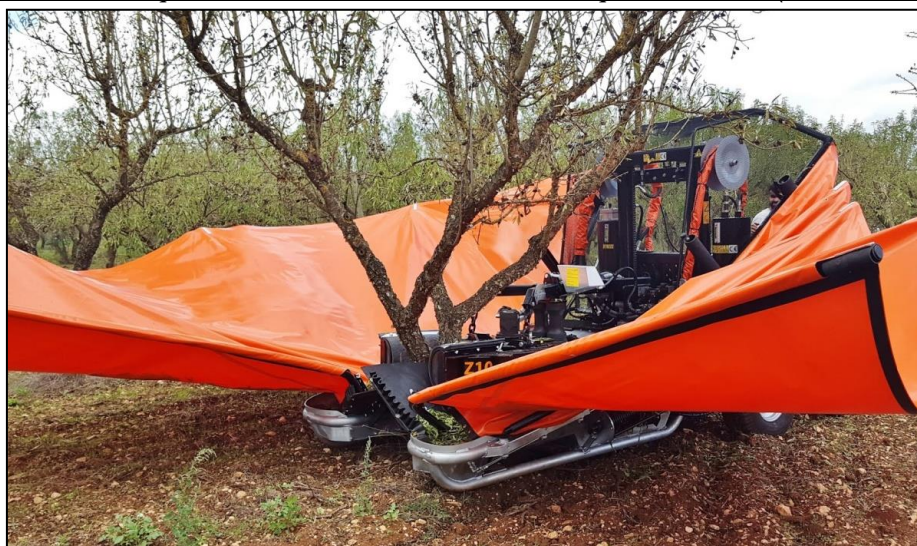
Figura 7.2: Macchina frontale per la raccolta delle olive/mandorle su impianto intensivo (Foto: Dott. Agr. Vito Vitelli)
