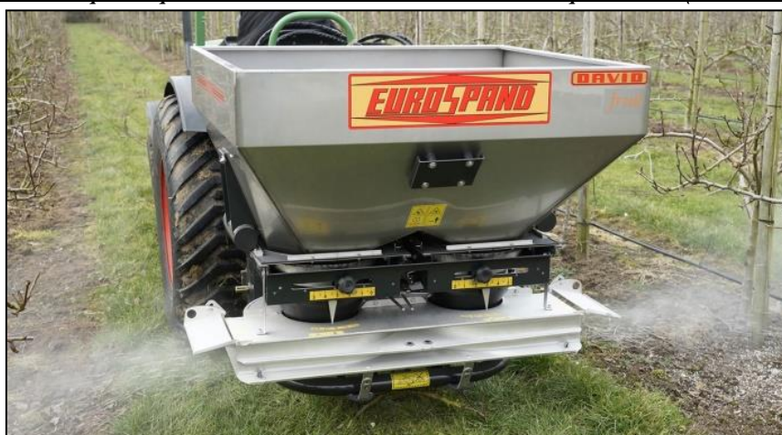
Figura 8.4: esempio di spandiconcime localizzato mono/bilaterale per frutteti (Foto: EuroSpand)
