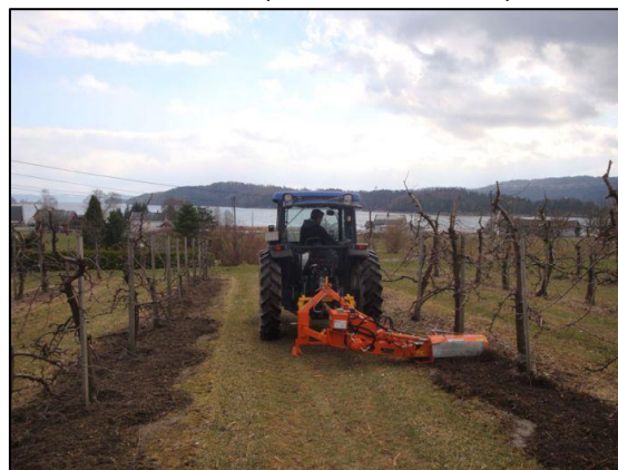
Figura 6.3: Esempio di fresatrice interceppo per le lavorazioni sulla fila (Foto: Rinieri S.r.l.)
