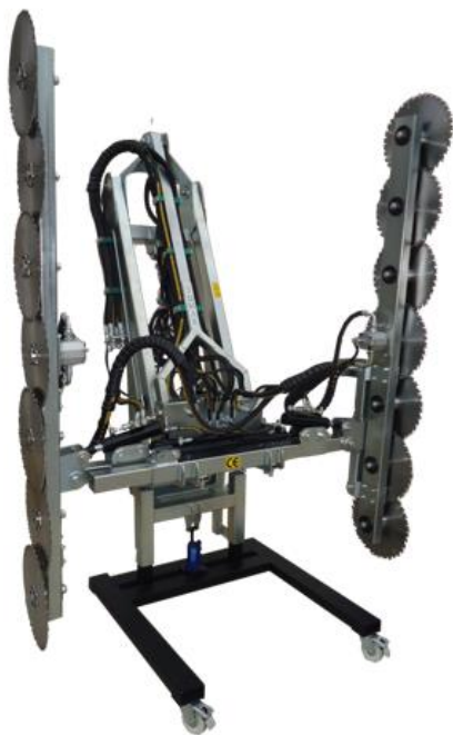
Figura 19- Dischiera per la esecuzione di topping ed heading laterale. Mod. Duplex (sinistra). Particolare di taglio (destra)
