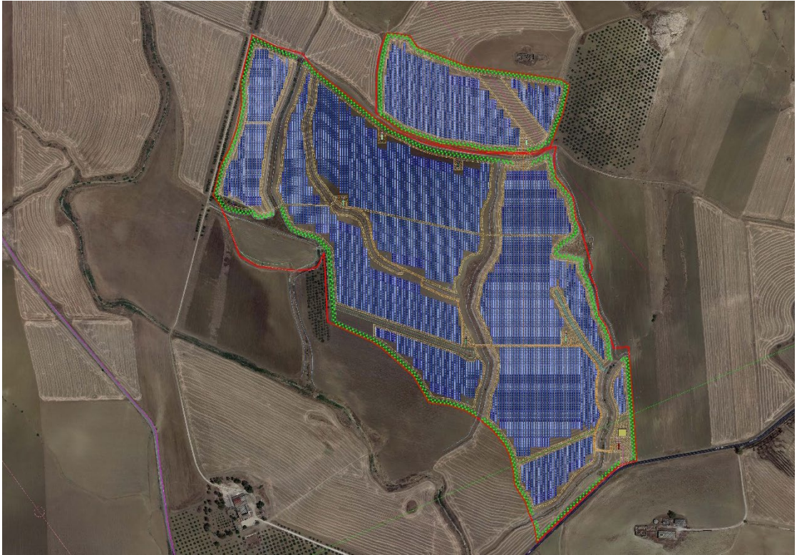
Figura 4 – Layout dell'impianto sul "Lotto Nord" su ortofoto.
