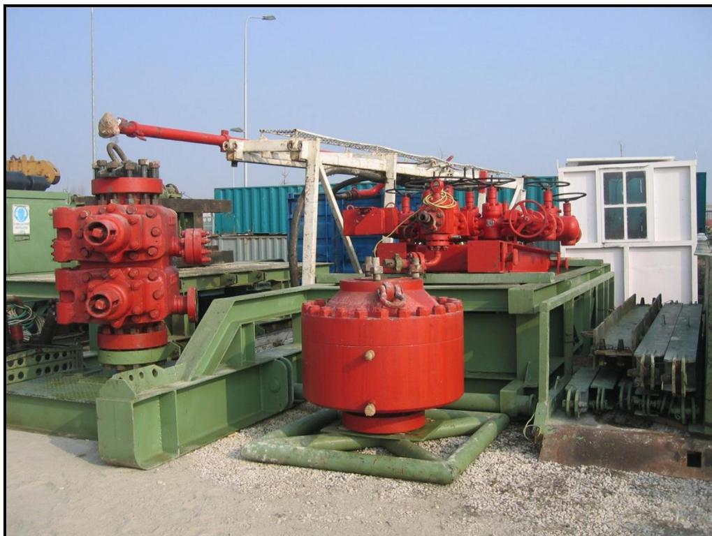
La testa pozzo si completa con almeno una valvola laterale (installata sotto al BOP) ed alla eventuale valvola maestra, a sua volta collegata ad una tubazione che permette di pompare fluido in pozzo per controllare la pressione in caso di necessità o per gestire nella maniera voluta eventuali emissioni di fluido dal pozzo stesso.
