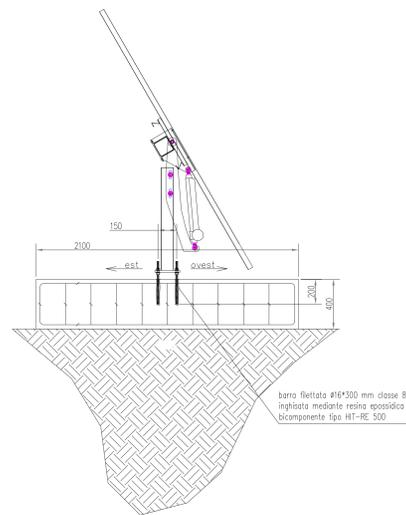
**PIANTA PLINTO/ZAVORRA DI FONDAZIONE - Scala 1:20**
