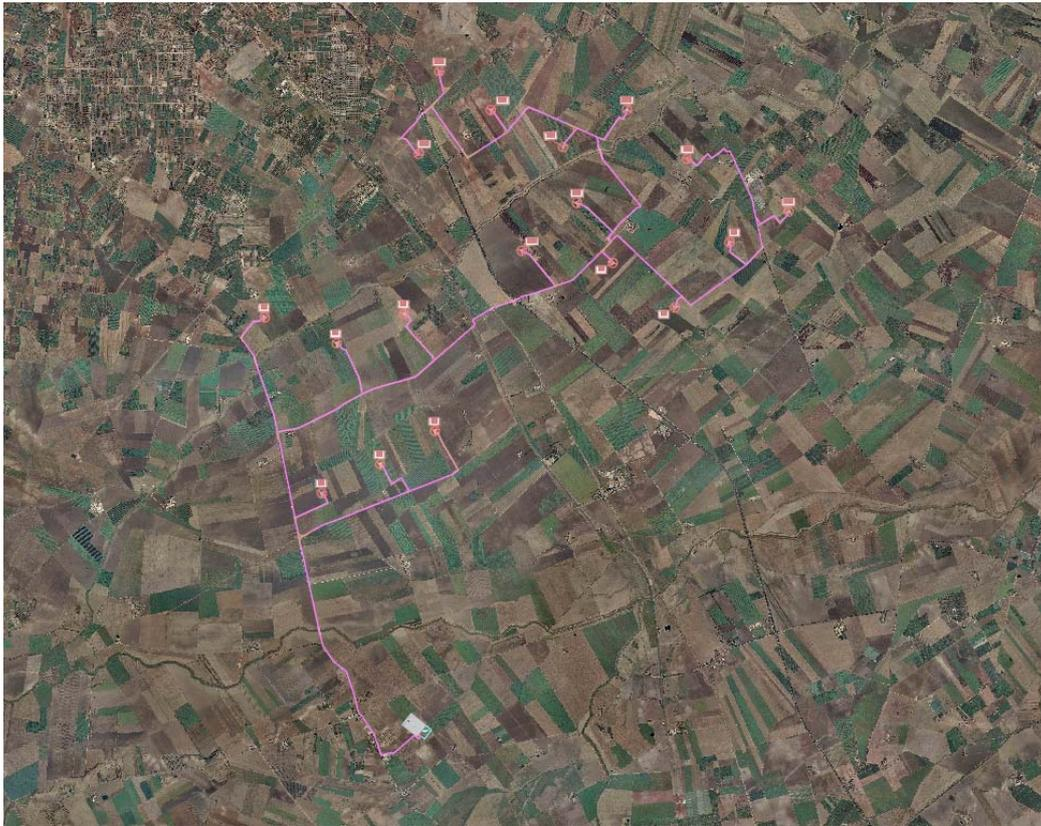
Il posizionamento degli aerogeneratori è stato effettuato tenendo conto delle condizioni di ventosità dell'area, della natura geologica del terreno, nonché del suo andamento plano-altimetrico.
