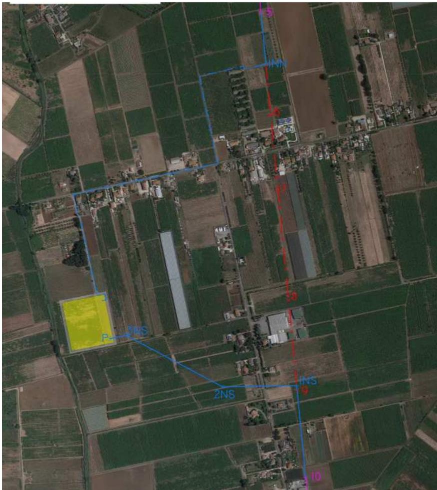
**Immagine n.3: inquadramento nuova SE 150kV/36kV e nuovi raccordi 150 kV**
