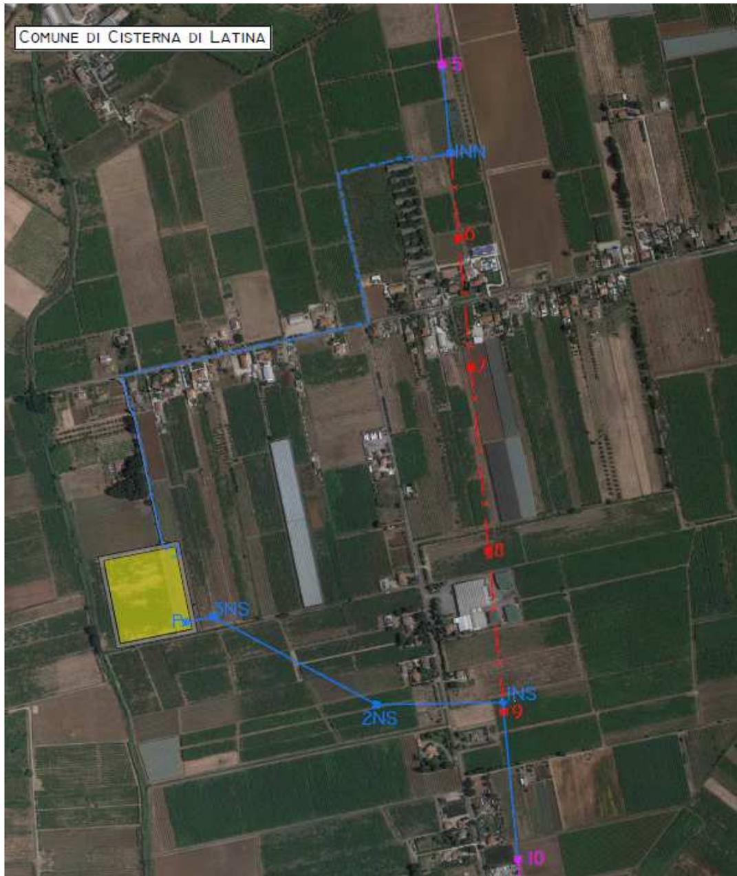
Immagine n.5: inquadramento nuova SE 150kV/36kV e nuovi raccordi 150 kV
