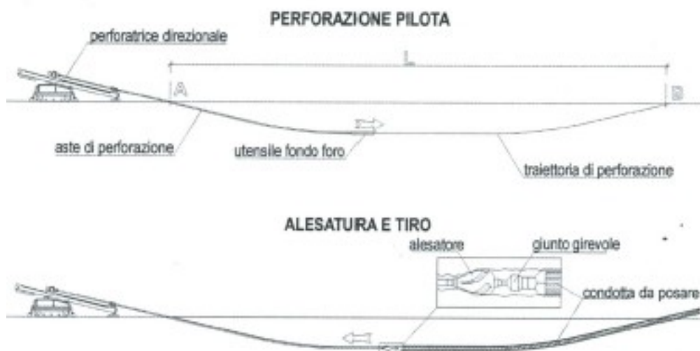
Schema semplificato del sistema di trivellazione T.O.C.
