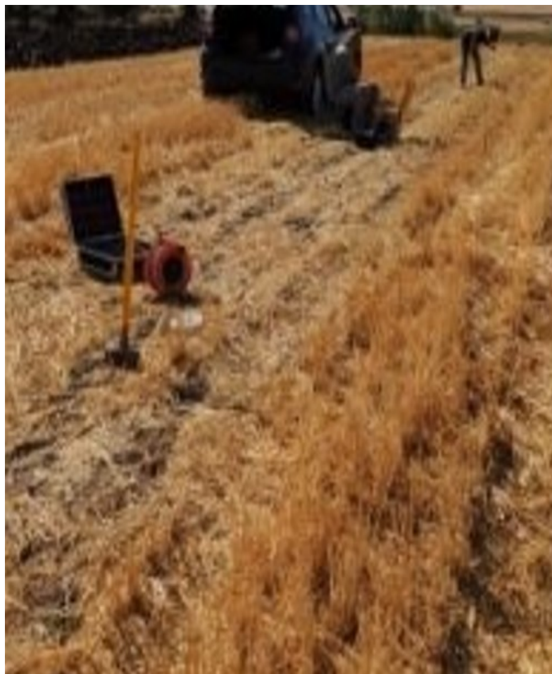
Fig. 1 – Prospezione sismica MASW n.1
