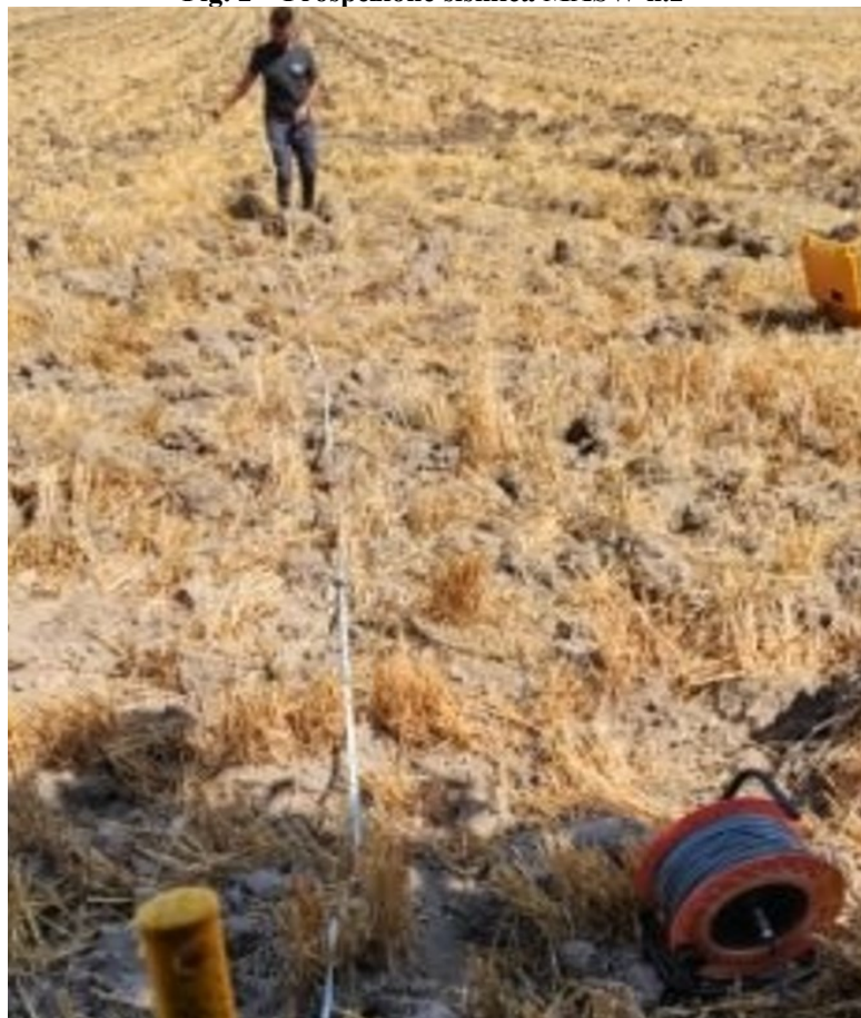
Fig. 3 – Prospezione sismica MASW n.3
