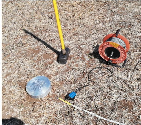
Fig. 5 – Sorgente energizzante, costituita da massa battente su piastra di alluminio. Come starter/trigger è stato utilizzato un geofono verticale Geospace a 14Hz.
