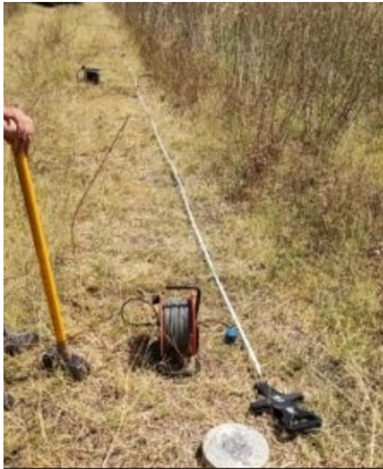
Fig. 2 – Prospezione sismica MASW n.2
