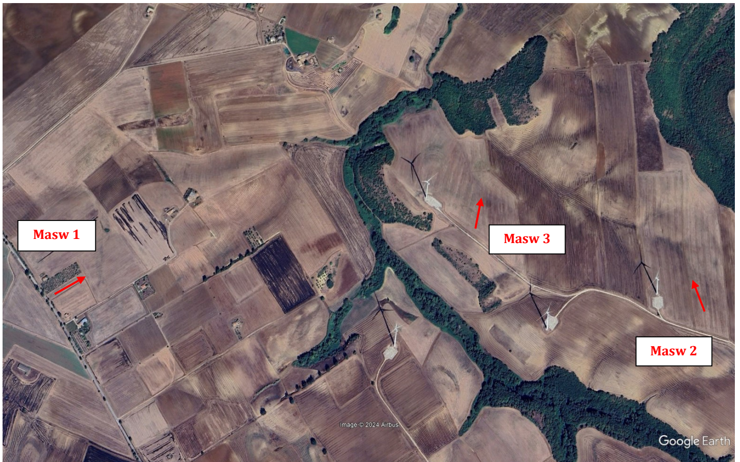
Fig. 4 – Ubicazione degli stendimenti messi in opera su foto aerea di Google Earth.
