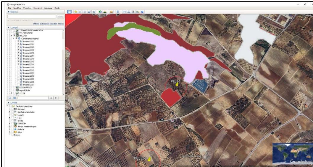
Figura 10: Sovrapposizione tra l'aerogeneratore PELE 01 e le aree percorse da incendio. **La proiezione dell'aerogeneratore ricade sulle suddette aree**
