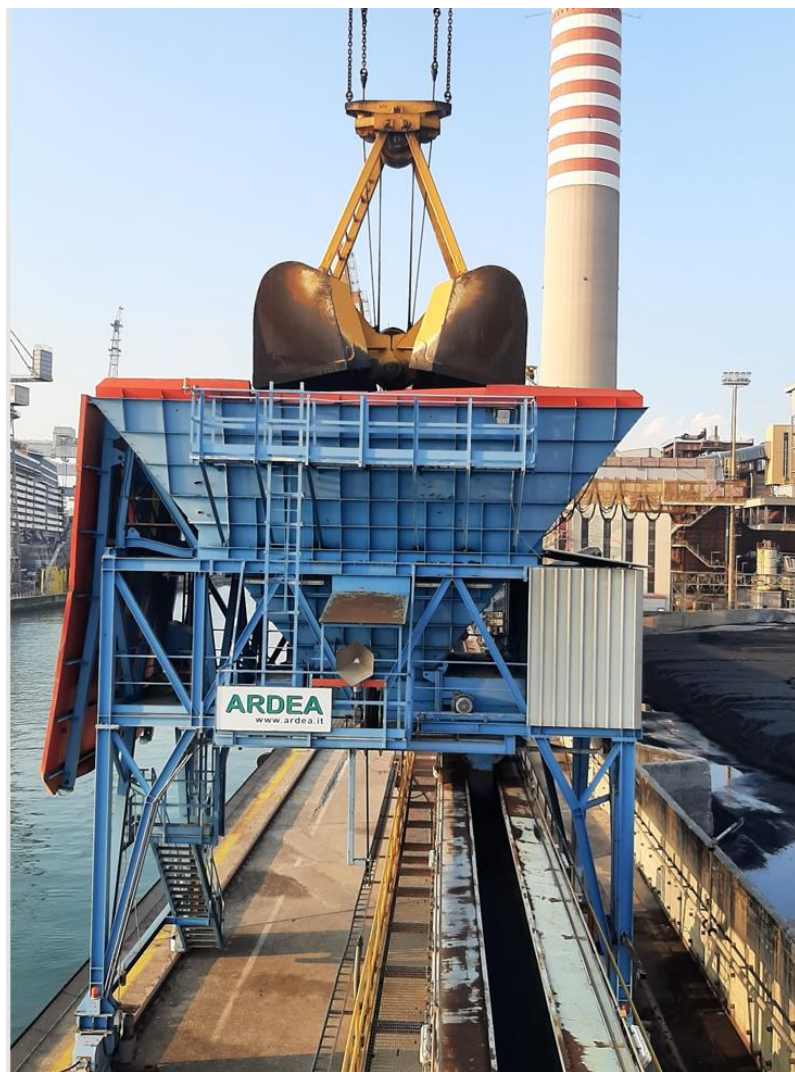
Figura 4: Scarico della gru Terex alla tramoggia di carico del nastro N1
