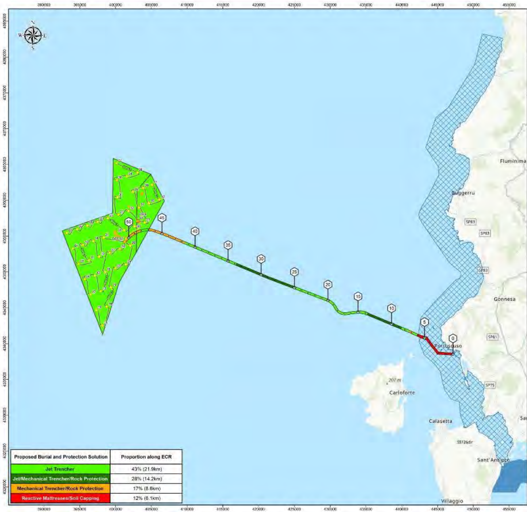
Figura 145 – Modalità di posa e protezione dei cavi proposte per l'installazione dei cavi elettrici di esportazione del progetto. Elaborazione CATHIE.
