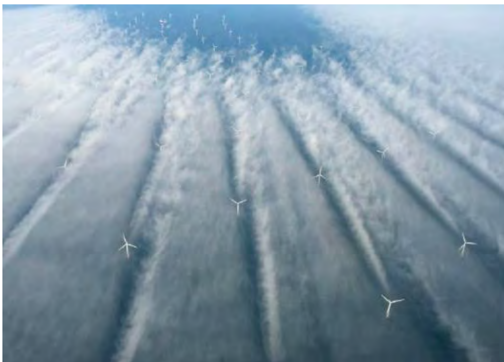
Figura 16 – Dissipazione di nebbia nell'impianto eolico offshore Horns Rev 2.
