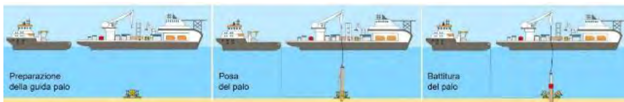
Figura 105 – Processo di piling, fasi caratteristiche.
