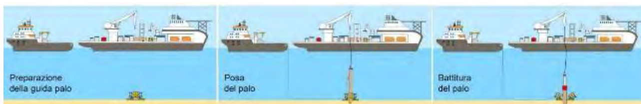
Figura 289 – Processo di piling, fasi caratteristiche.
