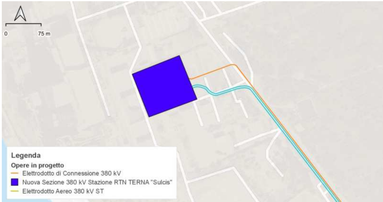
Figura 7.81 – Nuova Sezione 380 kV Stazione RTN TERNA "Sulcis" (configurazione con elettrodotto ibrido cavo/aereo).
