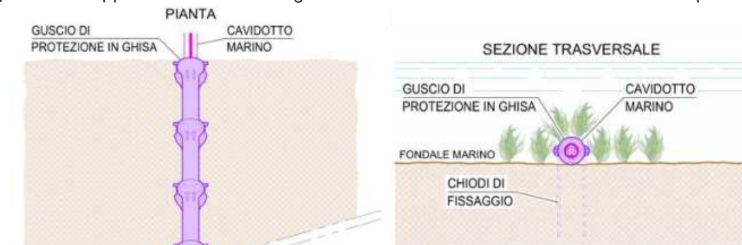
POSA ELETTRODOTTO DI ESPORTAZIONE MARINO - 220 kV AC
