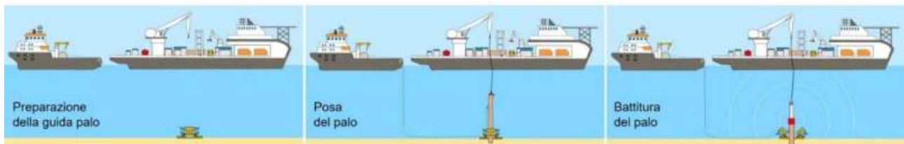
Figura 7.146 – processo di piling, fasi caratteristiche. Elaborazione iLStudio.
