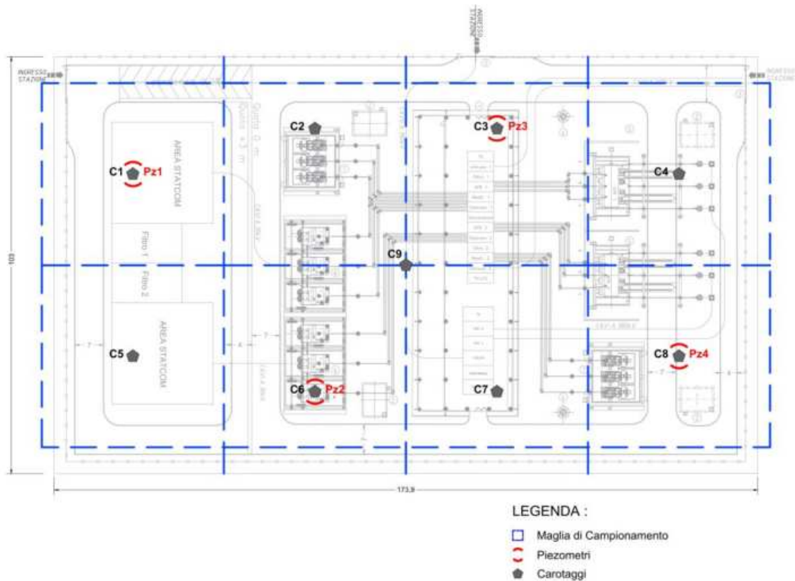
Figura 8.78 - Campionamento su sottostazione trasformazione, misura e consegna.
