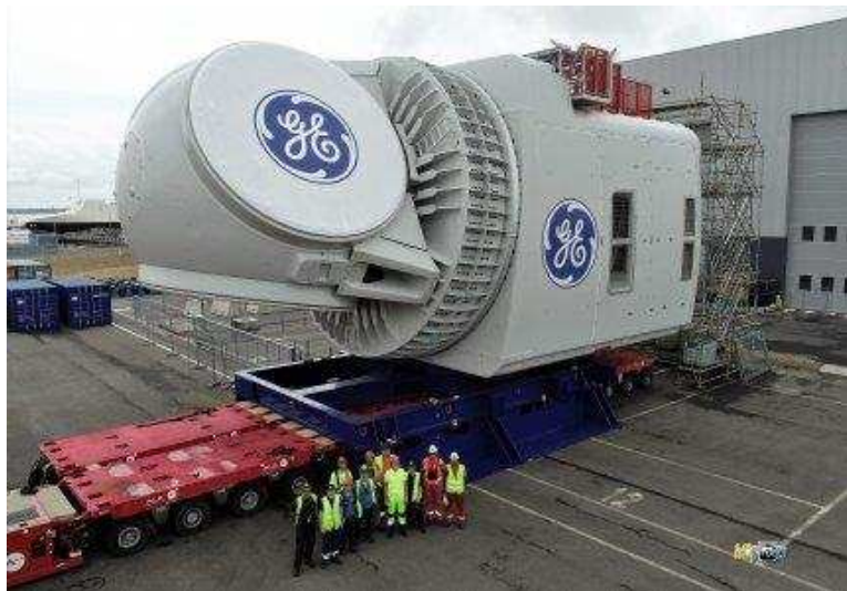
Figura 7.34 – Navicella di un aerogeneratore Haliade-X di General Electric.
