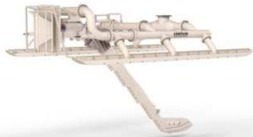
Figura 7.60 – Esempio di dispositivo per la posa in trincea del cavo.
