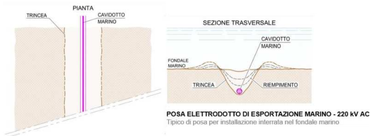
Figura 7.57 – Tipico di posa interrata dell'elettrodotto marino.
