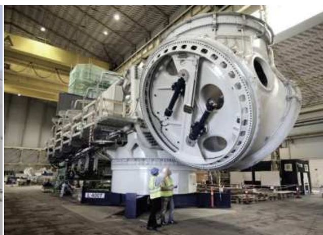
Esempio di sistema idraulico per la regolazione dell'angolo di pitch della pala.
