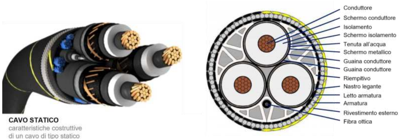
Figura 7.54 – Costruzione tipica di un cavo statico.
