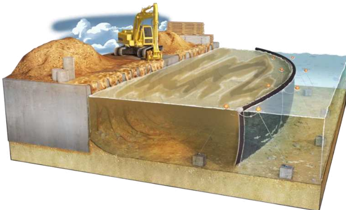
Figura 7.74 – Schema concettuale di funzionamento di una cortina anti-torbidità.
