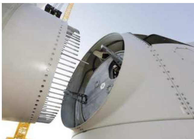
Dettaglio della giunzione tra la pala e il mozzo di una turbina eolica offshore.
