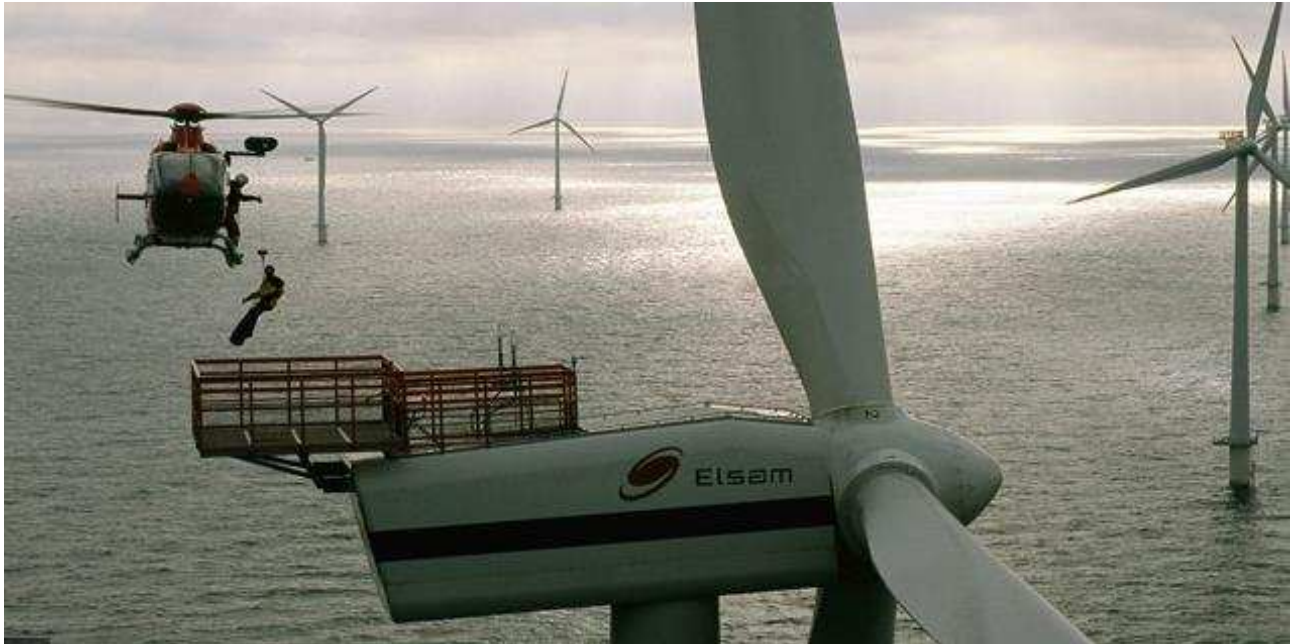
Figura 7.37 – Esempio di accesso alle strutture da elicottero (heli-winch).
