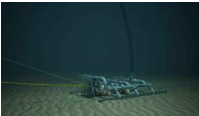
Figura 7.60 – Esempio di dispositivo per la posa in trincea del cavo.
