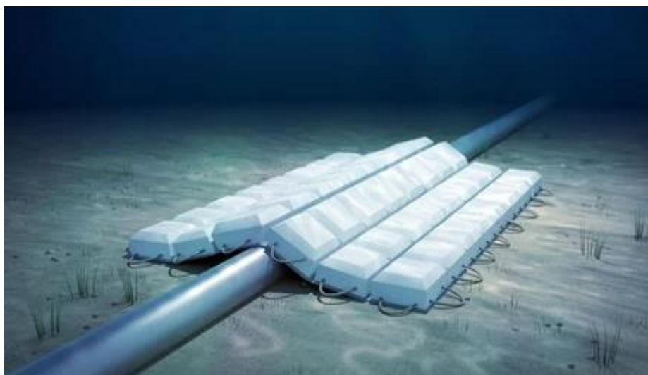
Figura 4.12 – Esempio di posa con protezione a materassi in cls (rendering).
