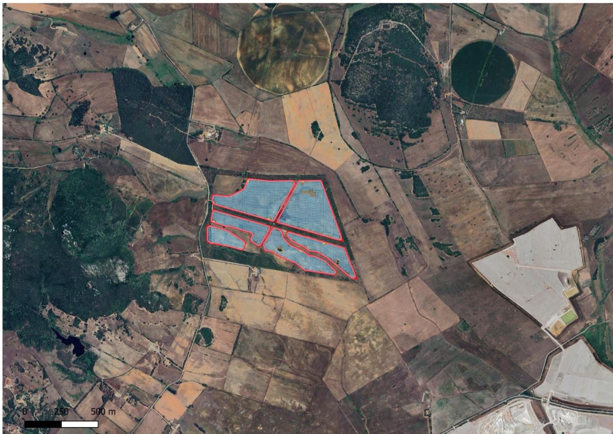
Figura 4.2 - Planimetria dell'impianto fotovoltaico
