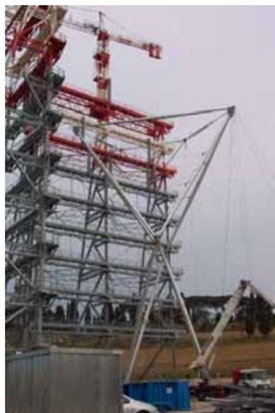
*Figura 3.2 – Prototipo di sostegno Castiglioni-De Lucchi e prototipo in fase di collaudo.*
