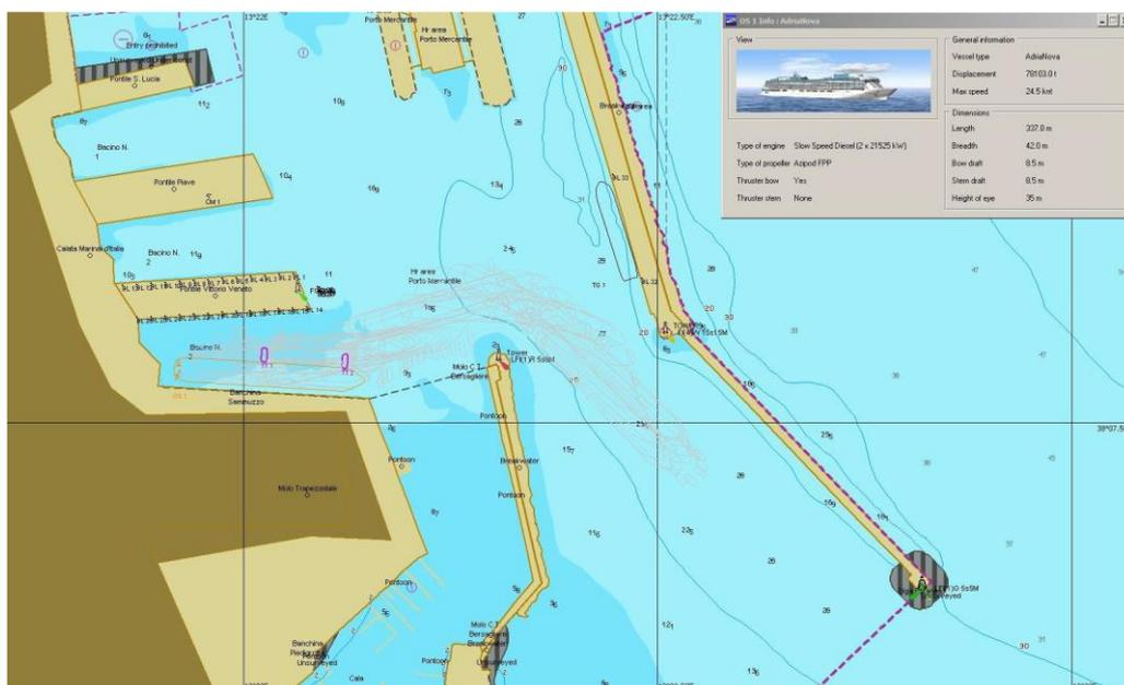
Figura 2-1: Simulazione di manovra di una nave da crociera con ormeggio al Molo Sammuzzo (fonte: "Valutazione, tramite simulazioni di navigazioni, della manovrabilità di grandi navi Cruise nel Porto di Palermo", Scenario Srl)
