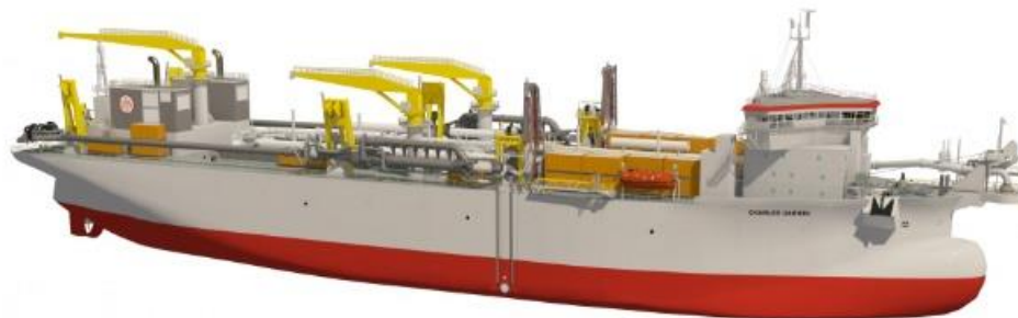
Figura 15- Nave attrezzata con sistema di aspirazione dei sedimenti
