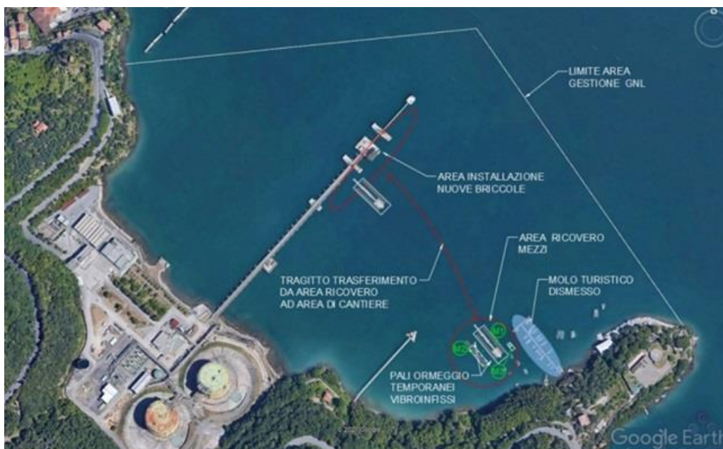
Figura 9 - Organizzazione del cantiere per l’infissione dei pali delle briccole
