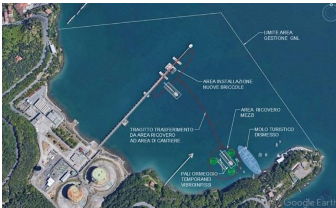
Figura 51 - Organizzazione del cantiere per l’infissione dei pali delle briccole
