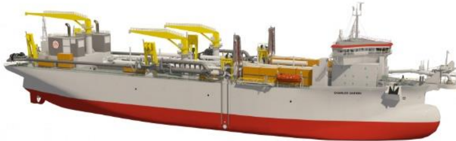
Figura 57 - Nave attrezzata con sistema di aspirazione dei sedimenti
