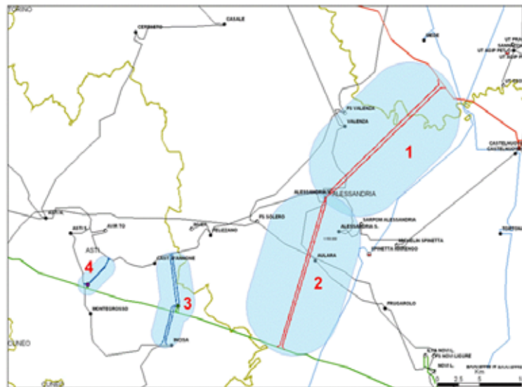
Figura 3.1 – Esempio di macroalternative, in risposta a un'esigenza di aumento di capacità di carico nella zona di Asti.
