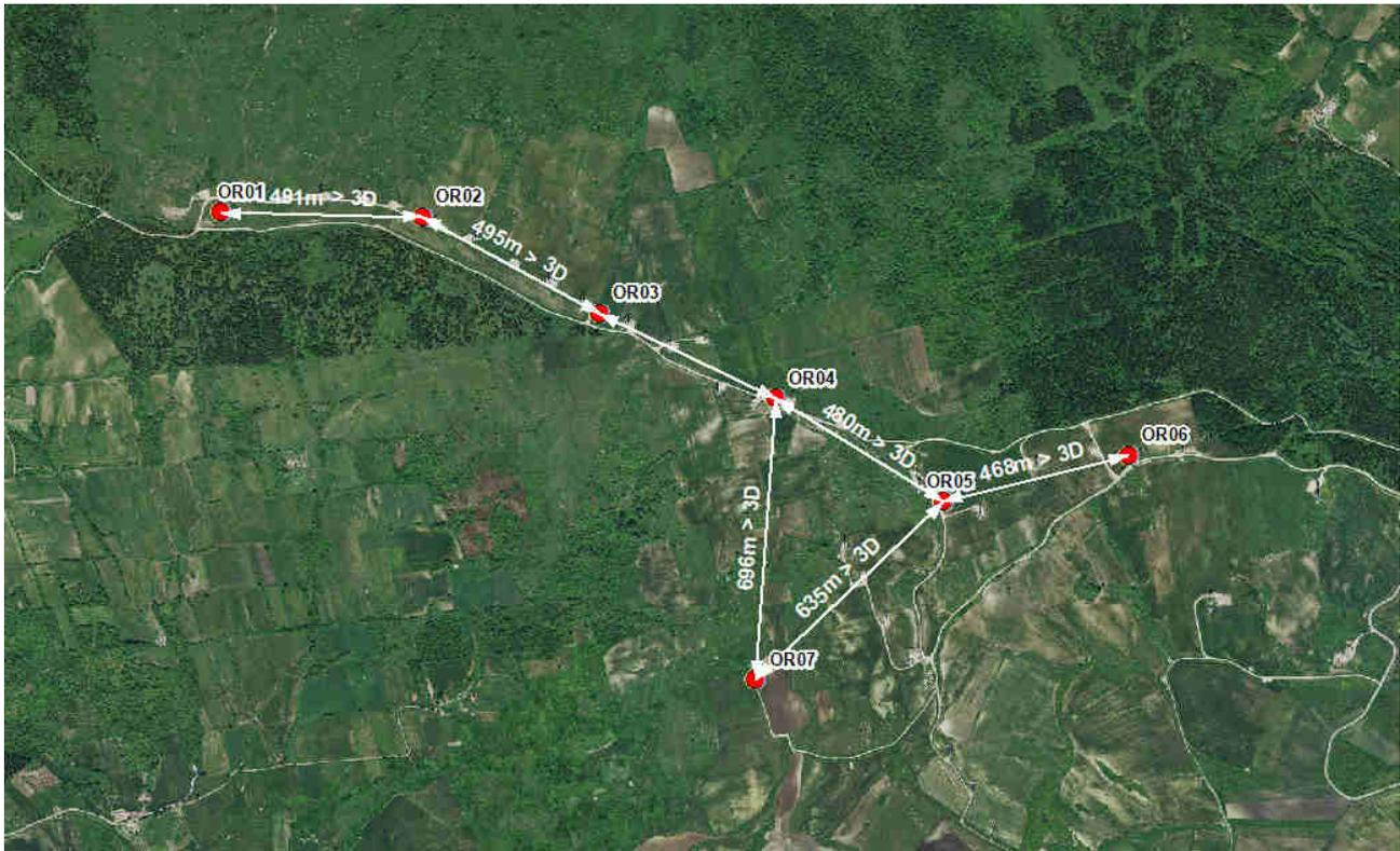
Figura 4 – Schema layout con indicazione delle interdistanze tra le turbine di progetto
