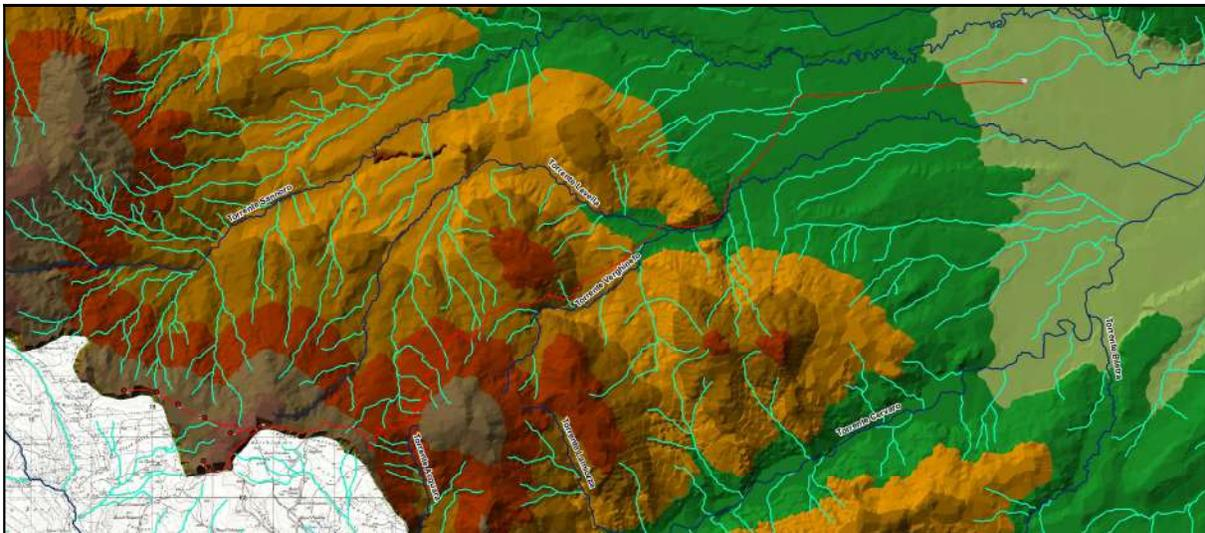
**Fig. 4:** ricostruzione tridimensionale del terreno con indicazione dei corsi d'acqua principali e secondari (in blu e azzurro) localizzati nell'area delle nuove opere da realizzare (in rosso).
