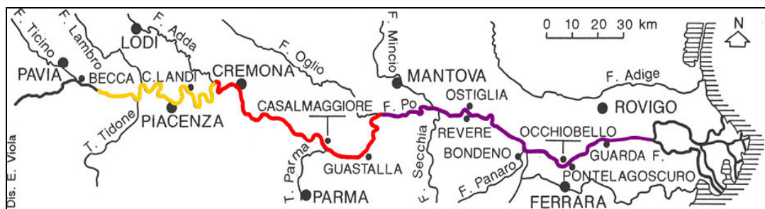
Figura 3.2.5: Alveotipi originariamente sviluppati dal corso d'acqua (in giallo: tratto unicursale a meandri fino all'Adda; in rosso: tratto a più canali di deflusso con isole interposte fra Adda e Oglio; in viola: tratto unicursale sinuoso-rettilineo fino alle diramazioni del Delta).
