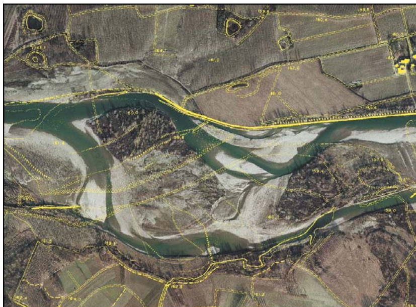
Figura 2 - alveo del fiume Po a Cavagnolo (TO), confronto tra l'ortofotocarta del 2004 e la cartografia dell'Ufficio idrografico per il fiume Po del 1988
