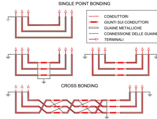
TIPICA SEZIONE CAVIDOTTO ALTA TENSIONE
