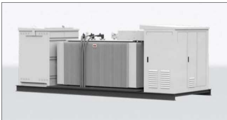
Figura 11 – Trasformatore di elevazione BT/MT da 2500kVA; 0,7/30kV
