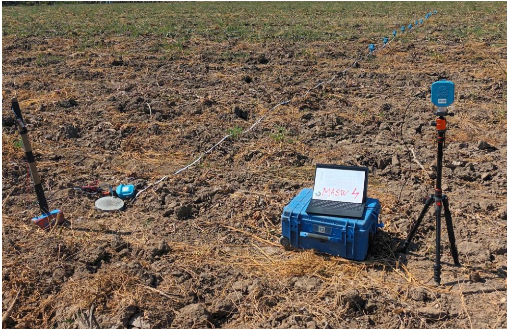
Postazione della MASW 04
