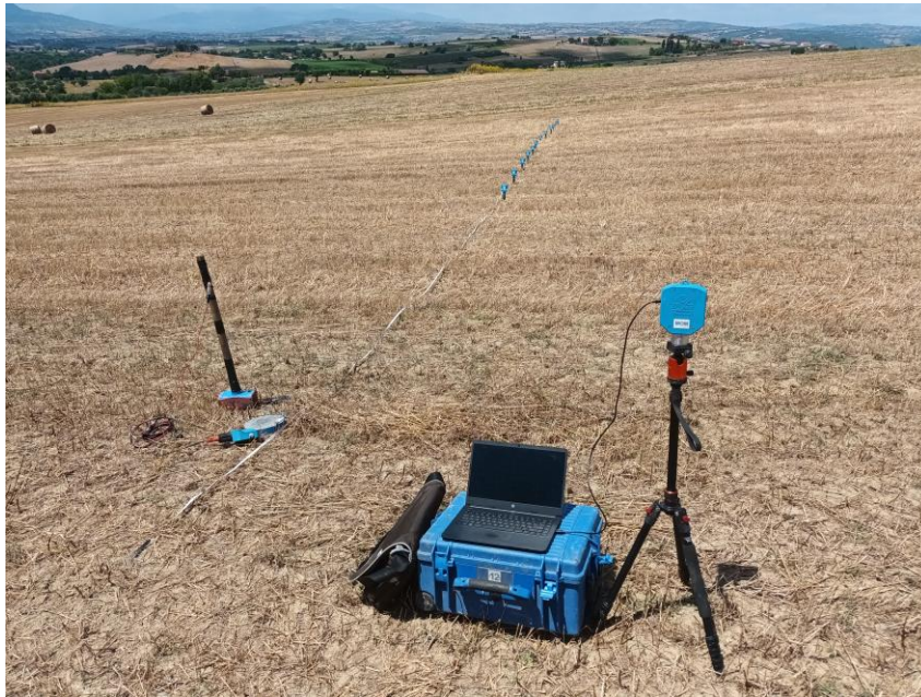
Postazione della MASW 16
