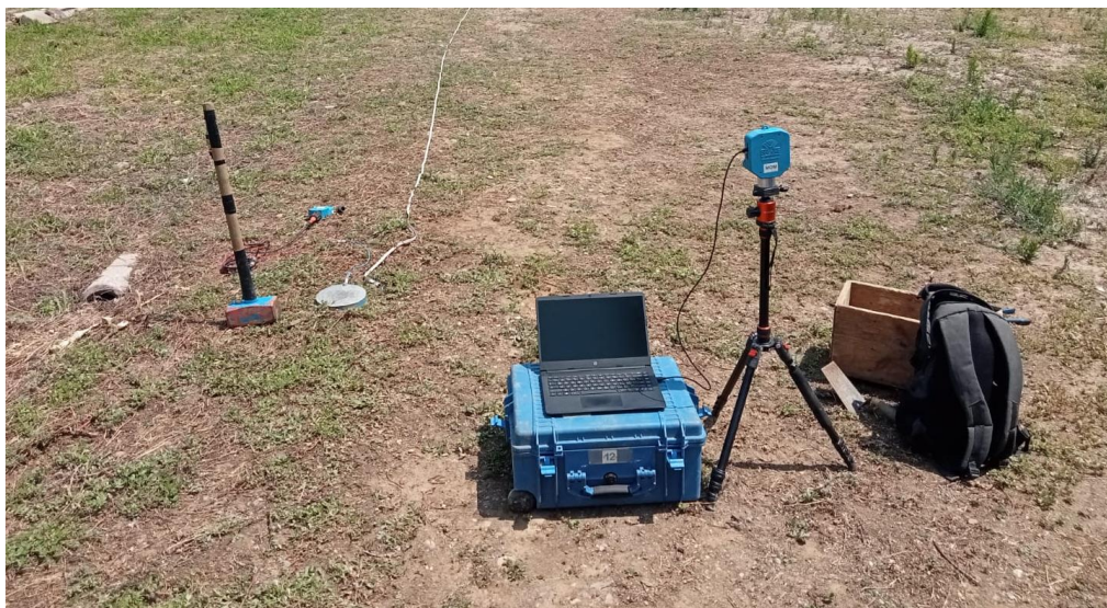
Postazione della MASW 02
