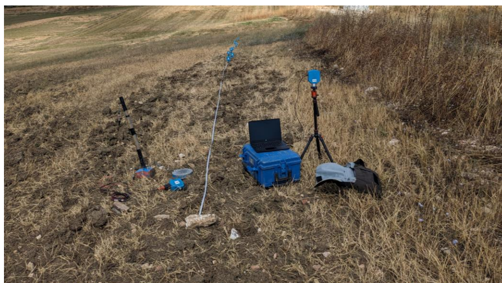
Postazione della MASW 11
