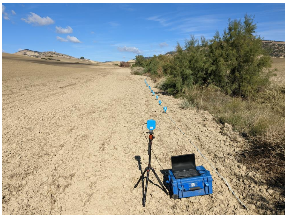
Postazione della MASW 07
