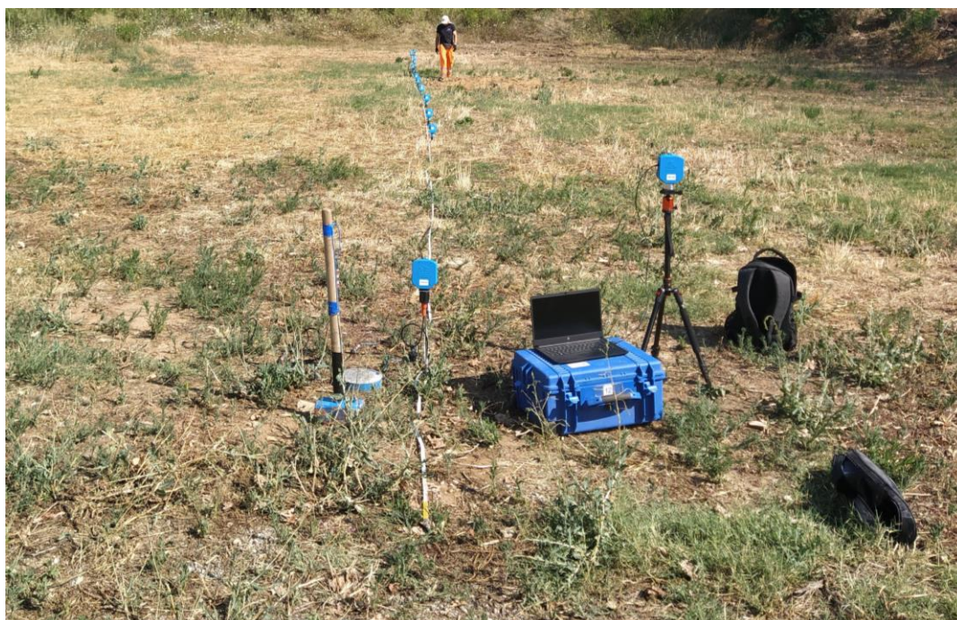
Postazione della MASW 13
